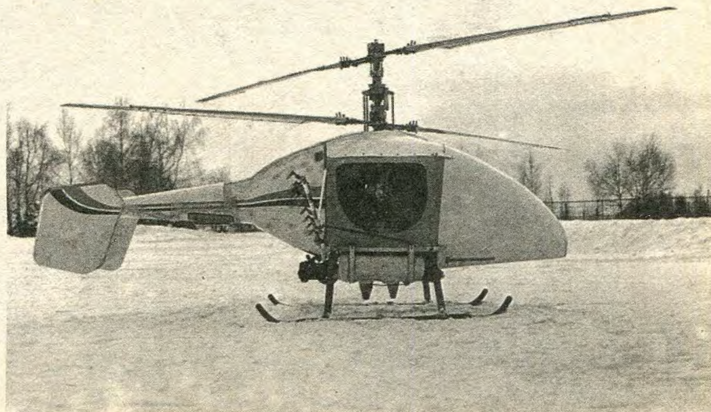
Беспилотный, многоцелевой Ка-37. Взлетный вес — 250 кг, силовая установка — 60 л.с., крейсерская скорость — 110 км/ч, статический потолок — 2500 м, полезная нагрузка — 50 кг. 1993 год.
