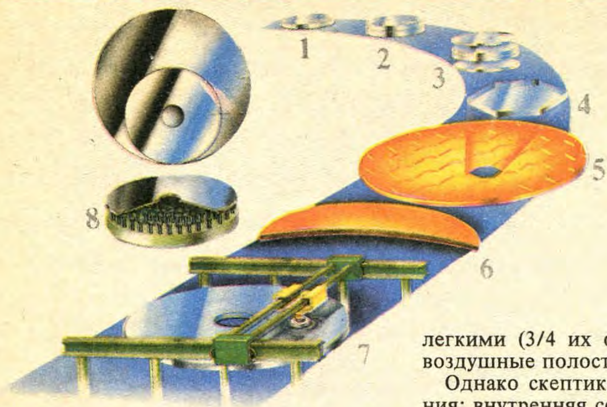
Так получают зеркала: 1 — стандартная заготовка из силикотитанового стекла, позволяющая изготовить наиболее распространенное 5-футовое (полуметровое) зеркало; 2 и 3 — если зеркало больших размеров, несколько заготовок складывают вместе; 4 — для «сотового» же зеркала сверхбольших размеров диск трансформируется в гексагональный, шестиугольный сегмент; 5 и 6 — сегменты складываются вместе, а затем сплавляются; 7 — заготовка подвергается окончательной шлифовке; 8 — готовое зеркало на подложке с механическими толкателями.
