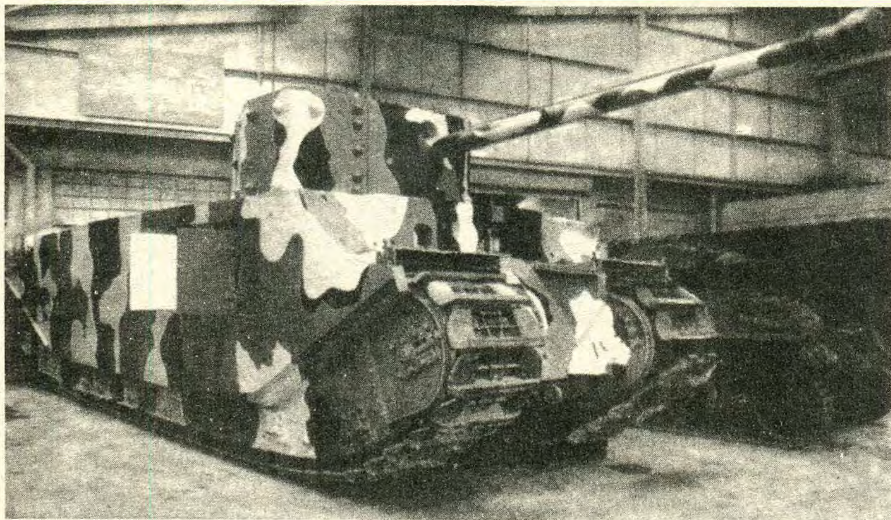
9. Английский тяжелый танк TOG-2, 1942 год: вес — 80 т, длина — 10,1 м, ширина — 3,1 м, высота — 3 м, максимальная толщина брони — 64 мм, вооружение — 76-мм пушка, пулемет, скорость — 14,5 км/ч, экипаж — 6 человек.
