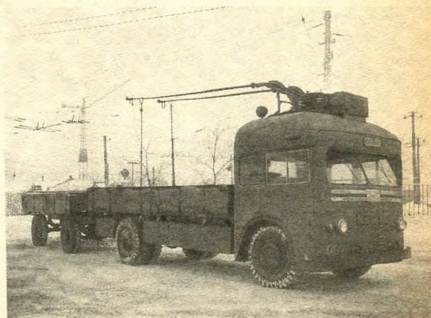
Опытный образец грузового ТБУ-3, построенного на ЗИУ в 1957 году.
