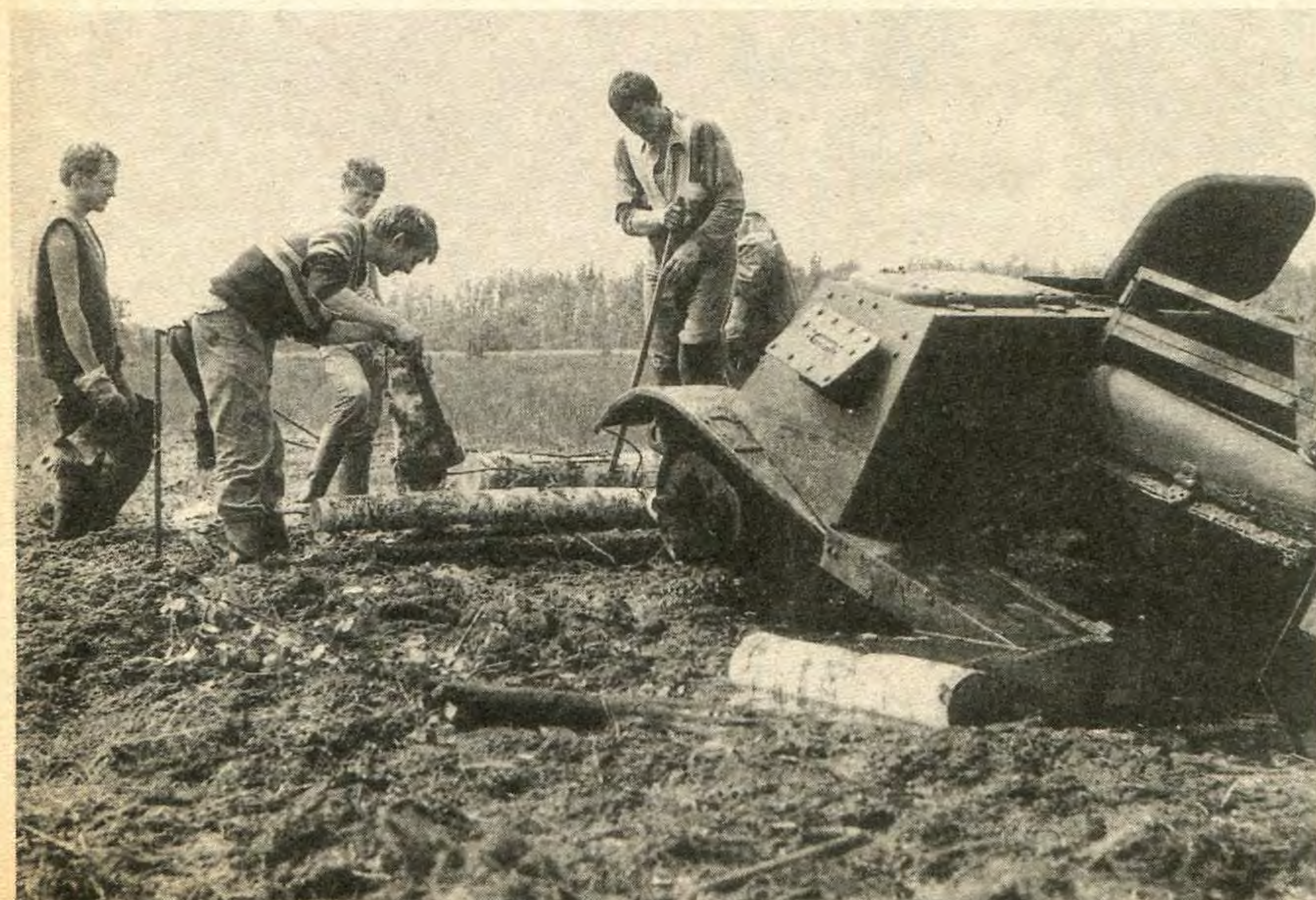
Корпус арттягача освобожден от грунта. Можно вытаскивать его из топи.
