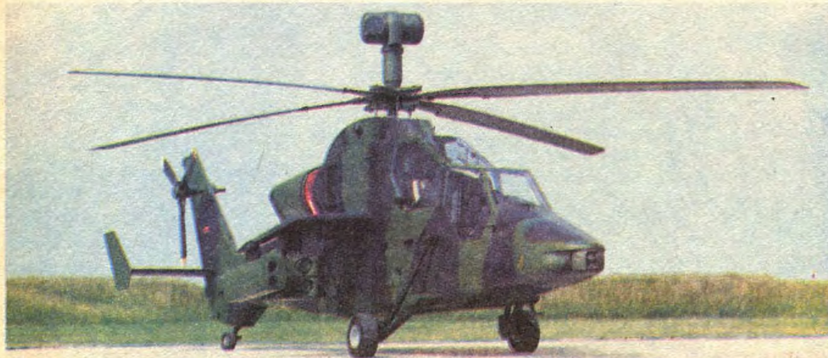
Франко-германский боевой вертолет «Тигр»: экипаж — 2 человека, силовая установка — два двигателя общей мощностью 2516 л.с., взлетный вес максимальный — 6 т, «сухой» вес — 3,3 т, скорость — до 280 км/ч, потолок — 2000 м, вооружение: 30-мм пушка, 8 противотанковых ракет «Хот» или «Тоу», столько же противосамолетных ракет «Стингер». Проходит испытания.
