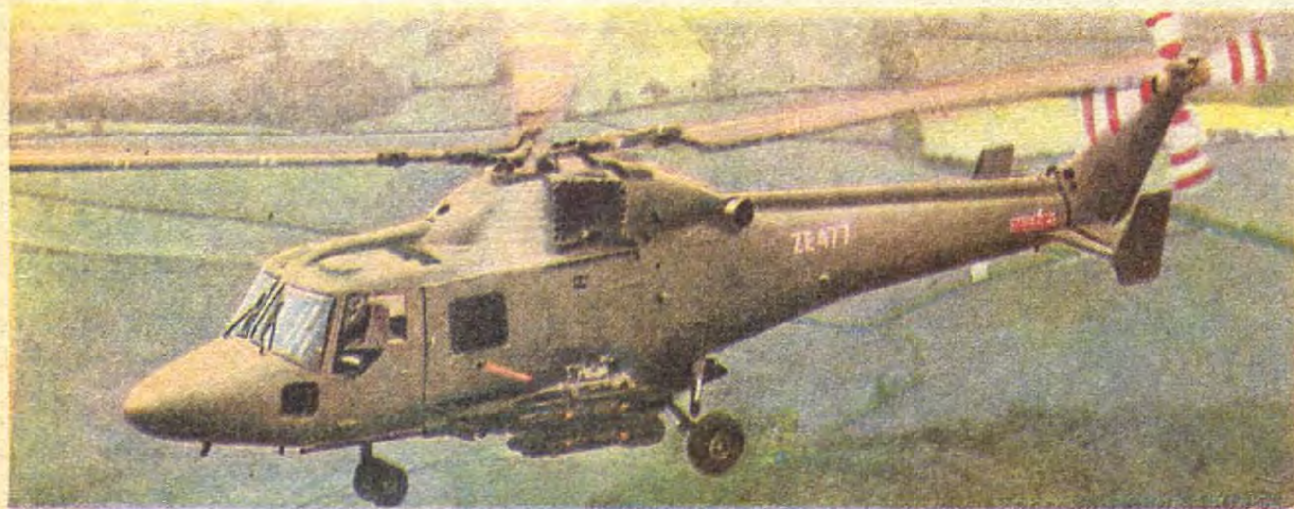
Английский боевой вертолет «Линкс-3»: экипаж — 2 человека, силовая установка — два двигателя общей мощностью 2700 л.с., взлетный вес максимальный — 5,4 т, скорость — 280 км/ч, дальность полета — 700 км, вооружение: 8 ракет «Тоу» или «Хеллфайер», 4 управляемые ракеты класса «воздух — воздух».
