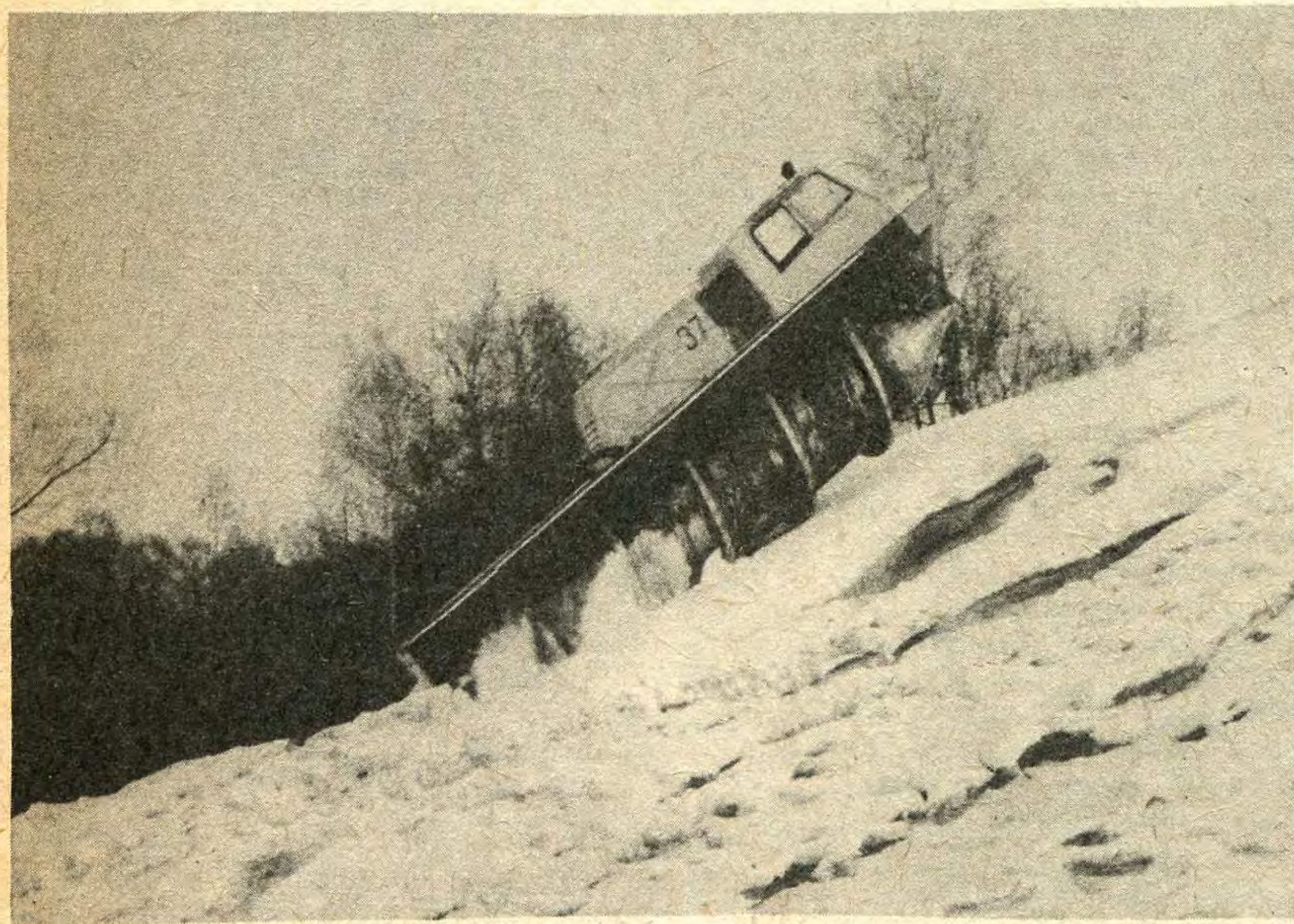
Моменты рабочих испытаний: подъем преодолевает шнекоход; на плаву — «синяя птица» (модификация — подъемный кран).
