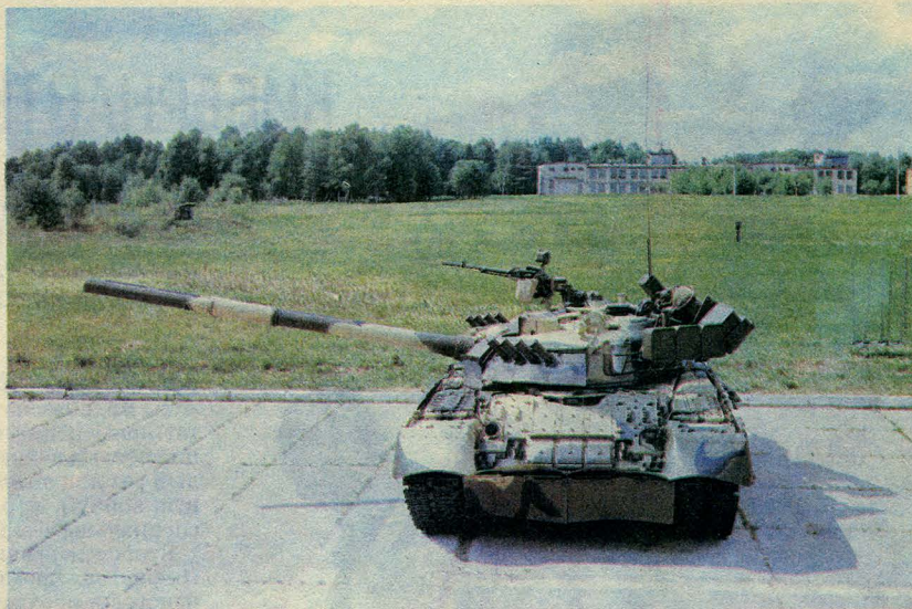
Танк Т-80. Башня развернута вправо, хорошо видны зенитный пулемет, защитный кожух на стволе, на борту башни дымообразующая система пуска дымовых гранат.
