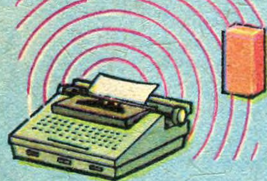
ДАТЧИК, ДИСТАНЦИОННО «СЧИТЫВАЮЩИЙ» ИНФОРМАЦИЮ С ЭЛЕКТРИЧЕСКОЙ ПИЩУЩЕЙ МАШИНЫ.
