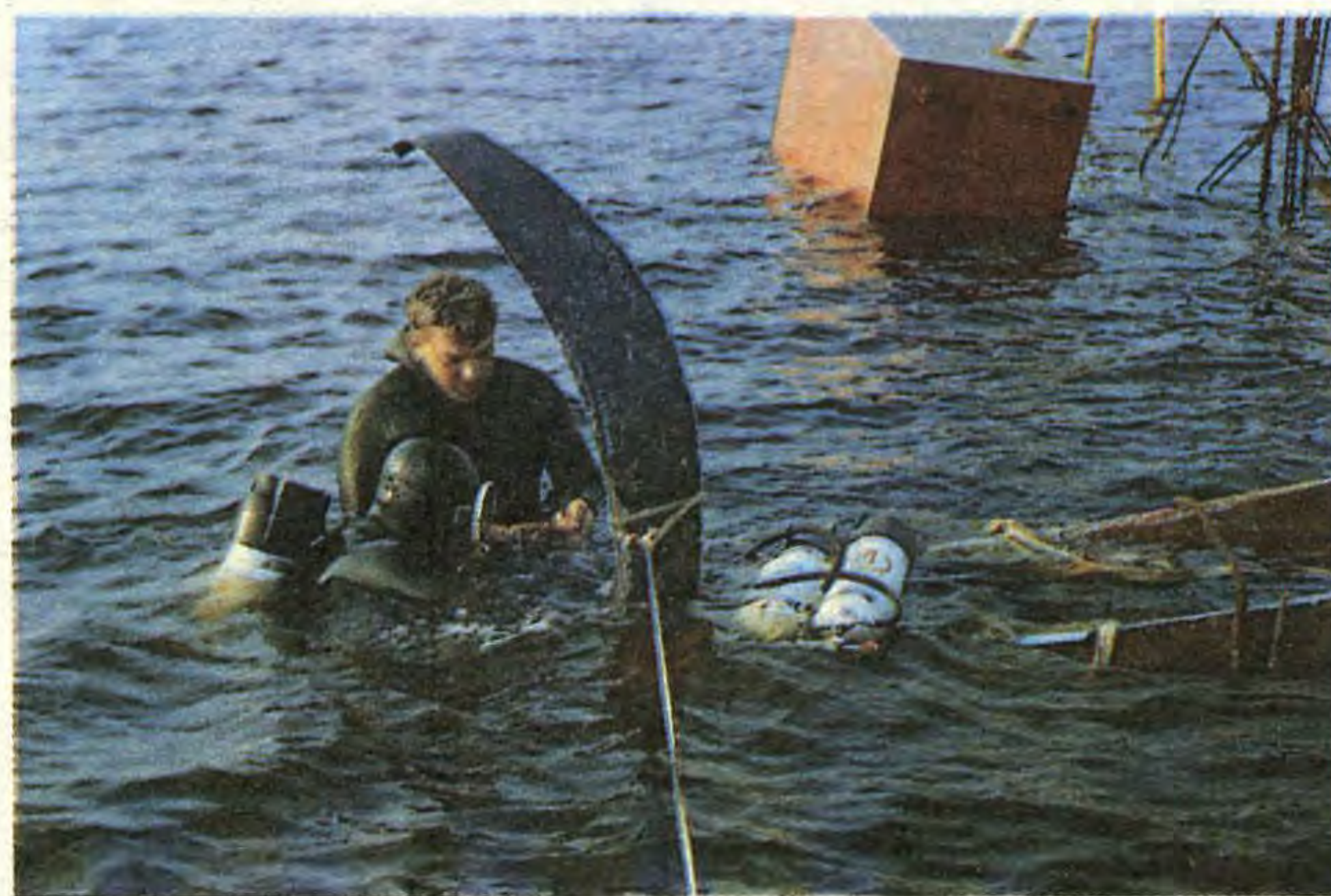
Самолет оторвали от грунта и подняли к подъемнику. На поверхности показалась лопасть пропеллера.
