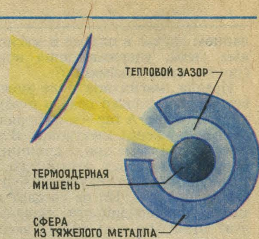
Рис. 6. Лазерная мишень в тяжелой металлической оболочке для использования эффекта самосжатия плазмы за счет спонтанных магнитных полей.
