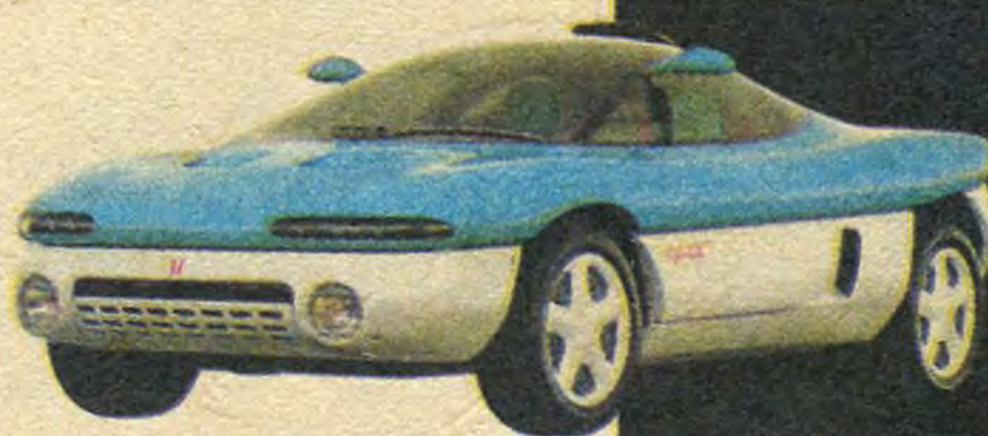
Седан высшего класса «Ниссан» UVX (Япония). Все колеса ведущие и управляемые, полная электронизация, навигационная установка. Коэффициент C_x — 0,25. Серийное производство начнется в 90-е годы.
