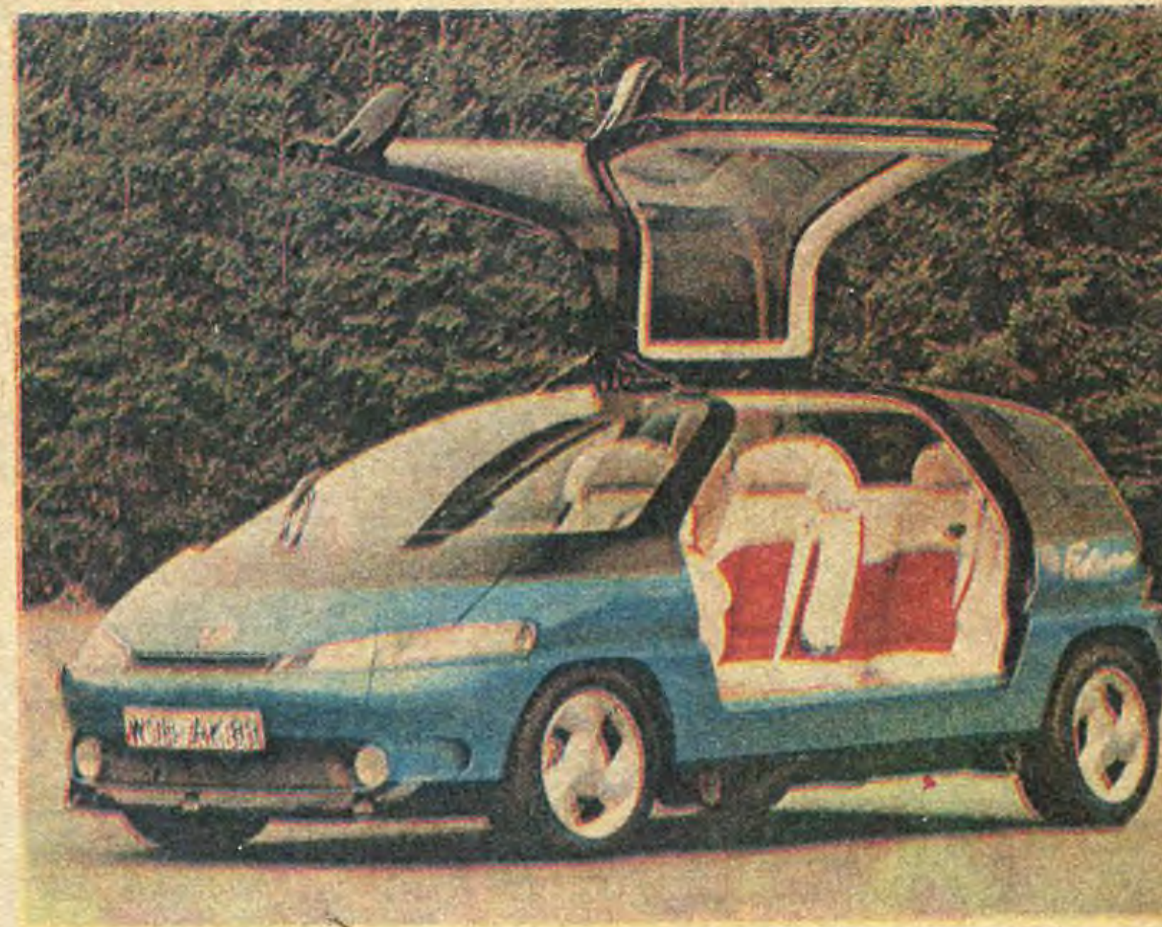
Малогабаритный «Фольксваген Футура» (ФРГ) с откидными дверями, управляемыми колесами, системой оповещения об опасности, электронной системой шумопоглощения. Двигатель в 82 л. с. с механическим нагнетателем и испарительной системой охлаждения.
