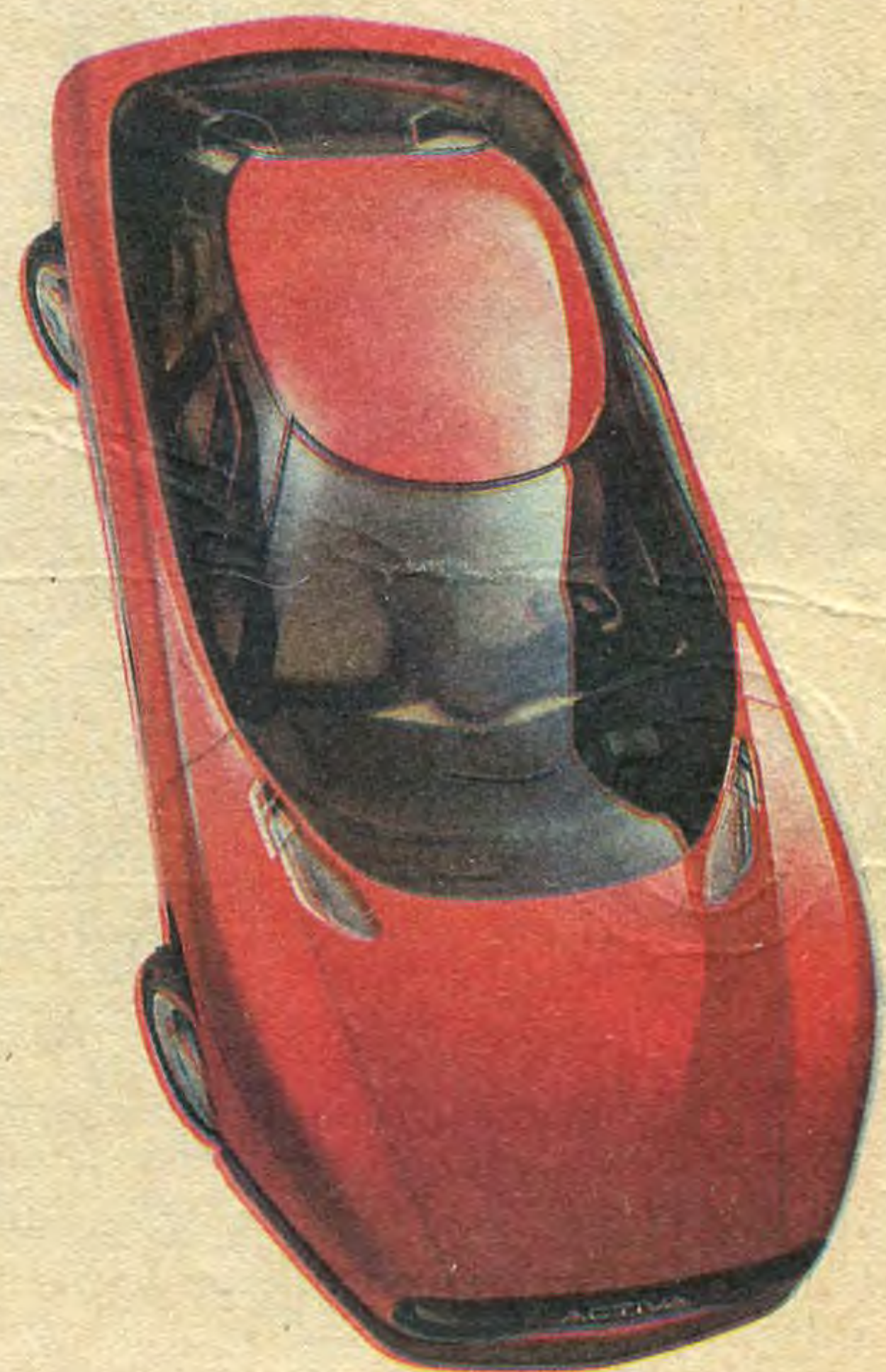
Таков «Ситроен Актива» (Франция) со всеми ведущими и управляемыми колесами, активной гидропневматической подвеской. Двигатель мощностью 220 л. с.
