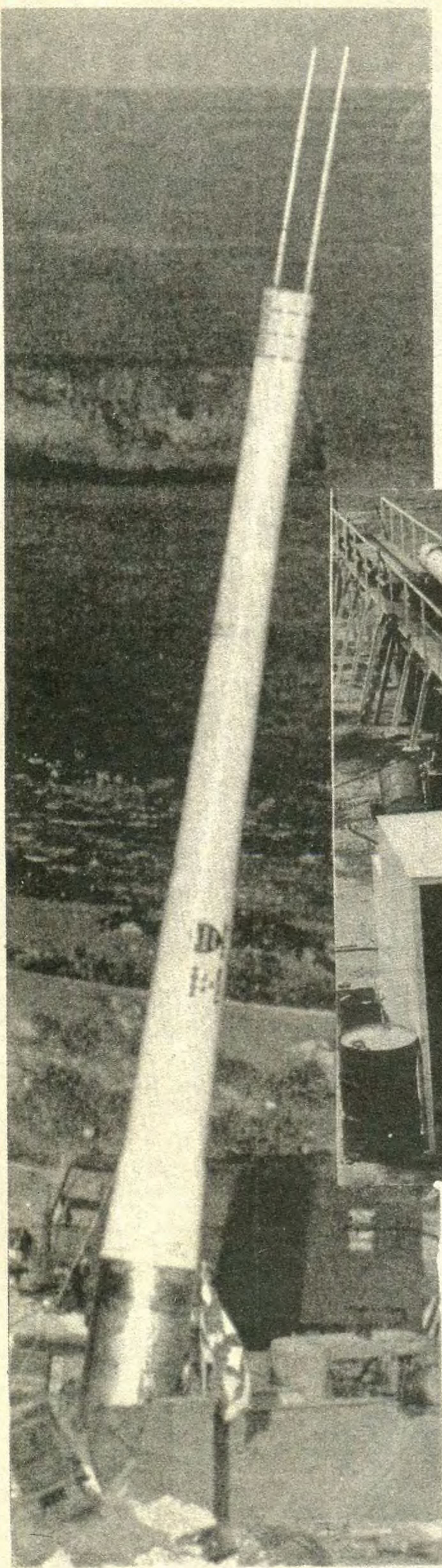
Ствол корабельного орудия, использовавшийся для испытательных стрельб.
