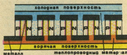
Схема полупроводникового термоэлемента.
