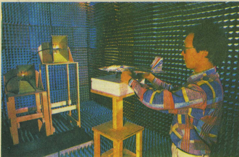
В лаборатории университета штата Мичиган: профессор Кун демонстрирует, как экспериментальный образец радара нового поколения «рисует» изображение самолета, роль которого пока играет плоская модель.
