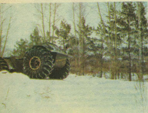
Возможности шины низкого давления демонстрирует В. Коновалов из Рыбинска на своей «Арктике-2». Давление колес очень мало, а это очень важно при движении по рыхлому снегу и легкоранимой растительной поверхности тундры. Кстати, в роли добровольца выступил корреспондент «ТМ».
