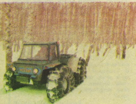
Надымский клуб «Вездеход» представил на конкурс 5 новых разработок. Две из них — на снимках: молодежный пневмокарт весом 250 кг и двигателем объемом 125 куб. см и грузовой вездеход В. Нелоева. Масса — 540 кг, дорожный просвет 43 см, кабина — цельнометаллическая, кузов — фанерный, двигатель от мотоколяски. Все четыре колеса — ведущие, рама — «ломающаяся».
