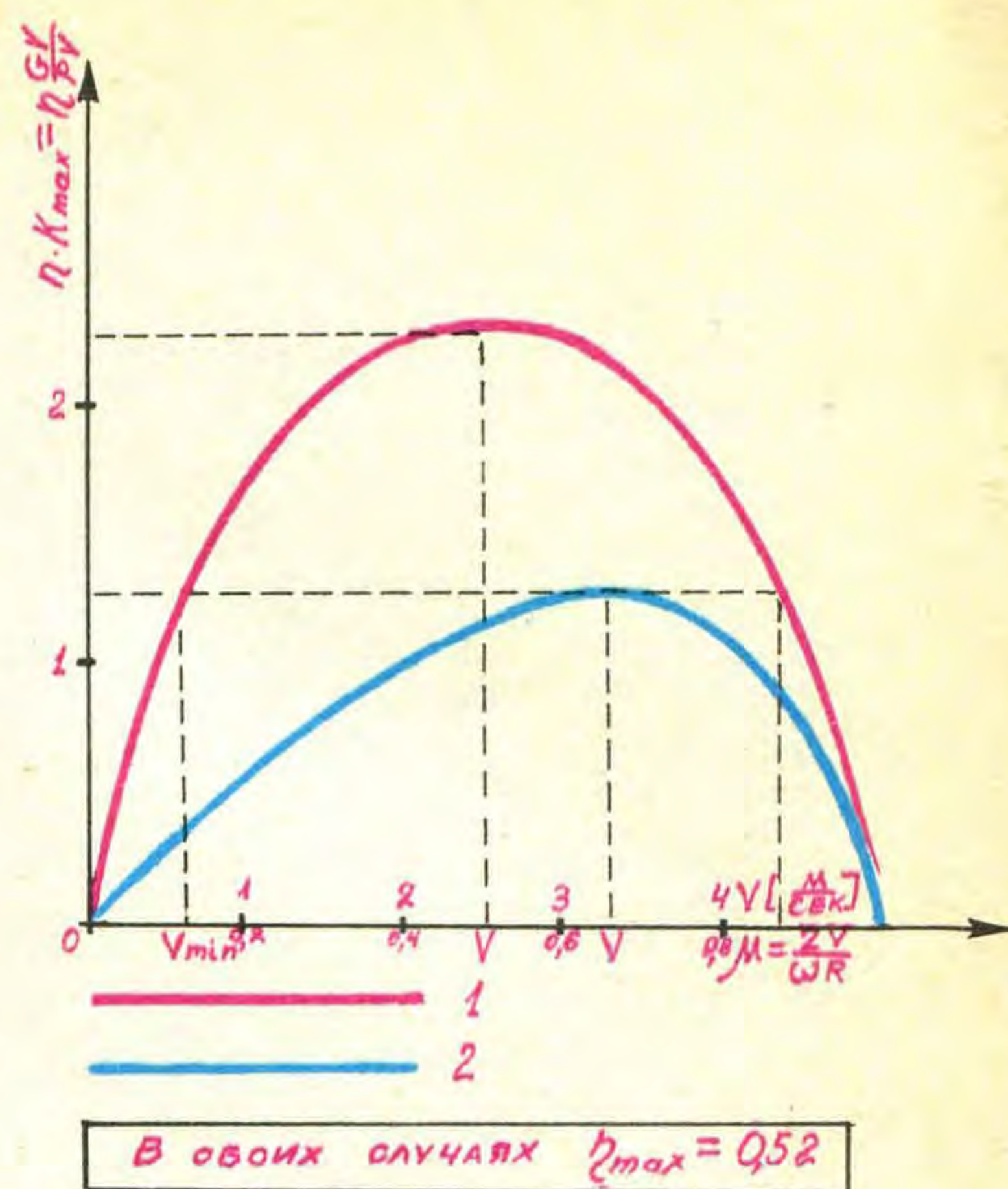
Р и с. 5. Сравнение кривых эффективности ( K_{max} ) обычного винтового (2) самолета и машины Болдырева (1). Обозначения: M — отношение скорости потока от предкрылка или винта к скорости набегающего потока; \eta — КПД силовой установки; G — полный вес аппарата или переносимой им полезной нагрузки; V — скорость перемещения груза; P — сила тяги, развиваемая силовой установкой; n — частота колебаний.
