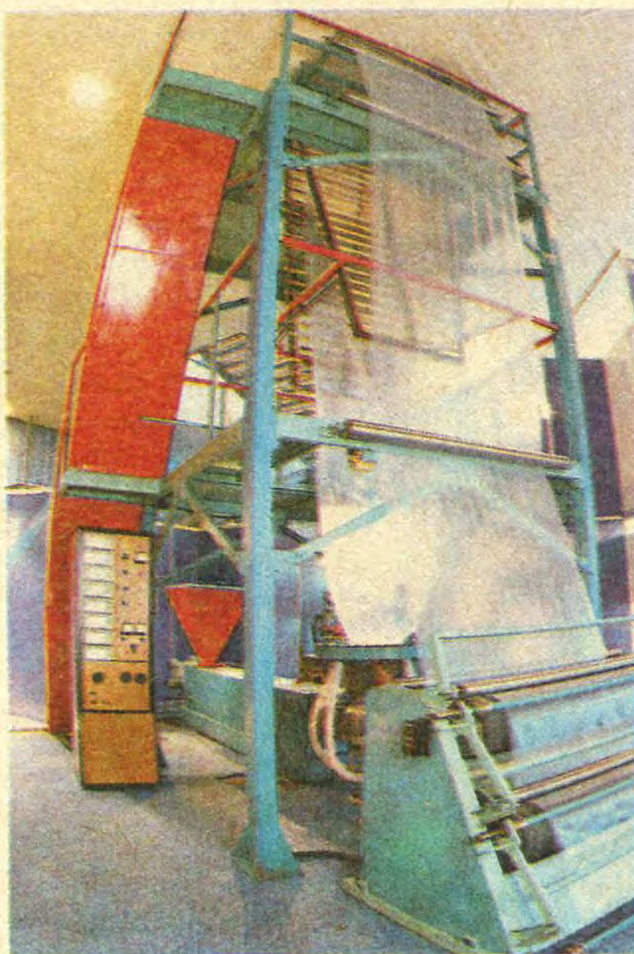
Линия для получения вторичного полиэтилена.
