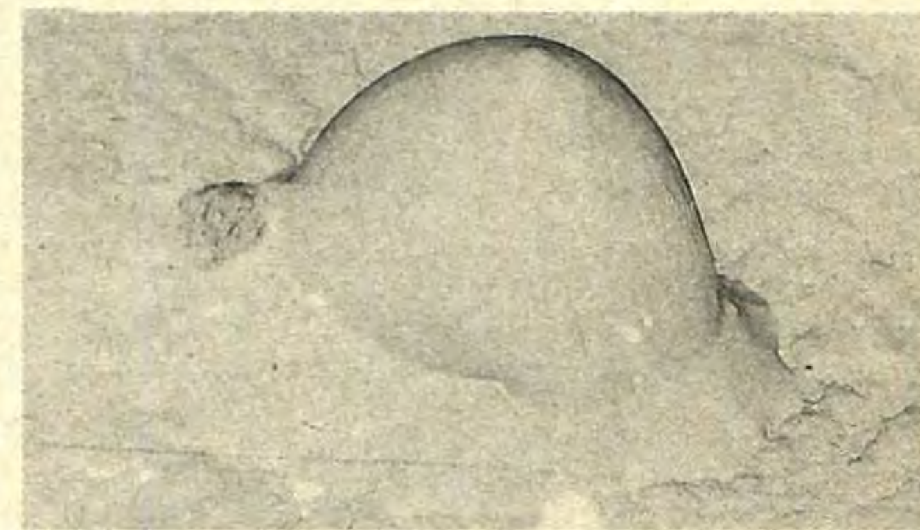
Фото 3. Столь «полногрудые» формы образуются при лазерном нагреве кремния. Возникший кристалл имеет вид идеальной полусферы. После того как он «созреет», на его вершине вырастет еще один маленький кристалл.
