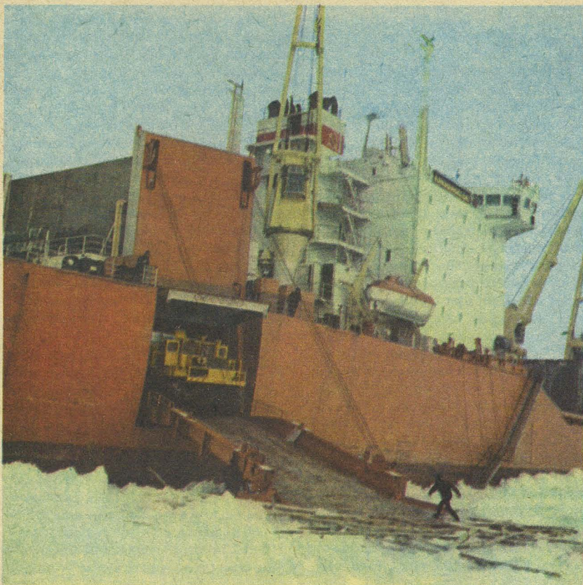
Раньше машины выгружались на лед с помощью подъемного крана. Впервые в практике опробовано специальное приспособление, напоминающее подъемный мост в средневековом замке, — аппарат.
