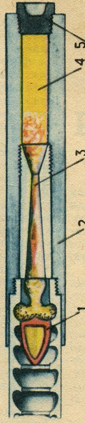
207. Схема ствола турбопушки Делама-Маз. Цифры и обозначения: 1 — снаряд, 2 — ствол, 3 — сопло, 4 — камера, 5 — затвор.
