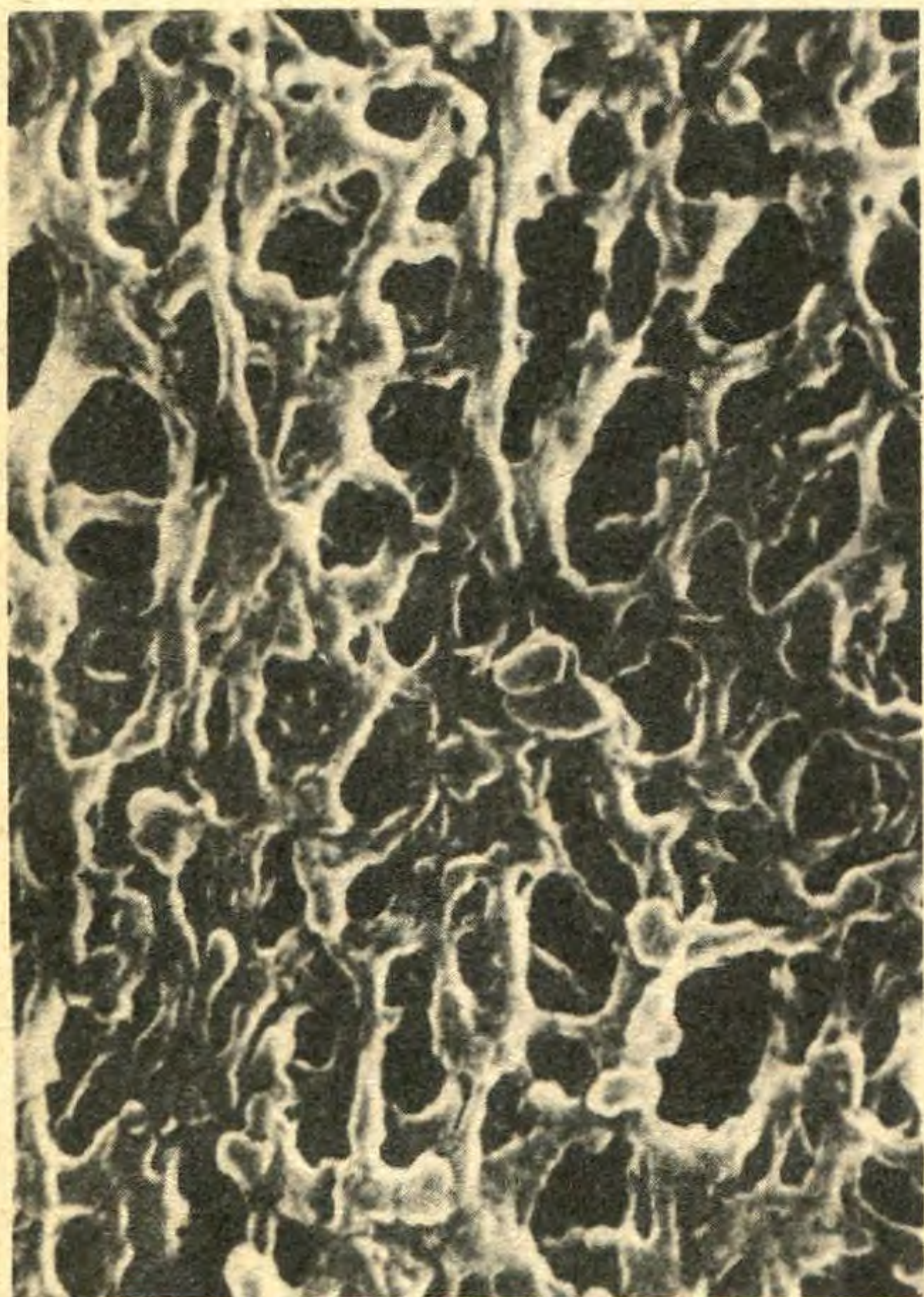
Микрофильтрующая ацетатная мембрана в электронном микроскопе.
