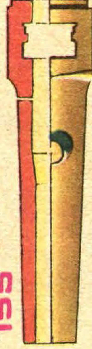
156. Стальной ствол 2,5-дюймовой казнозарядной горной пушки.
