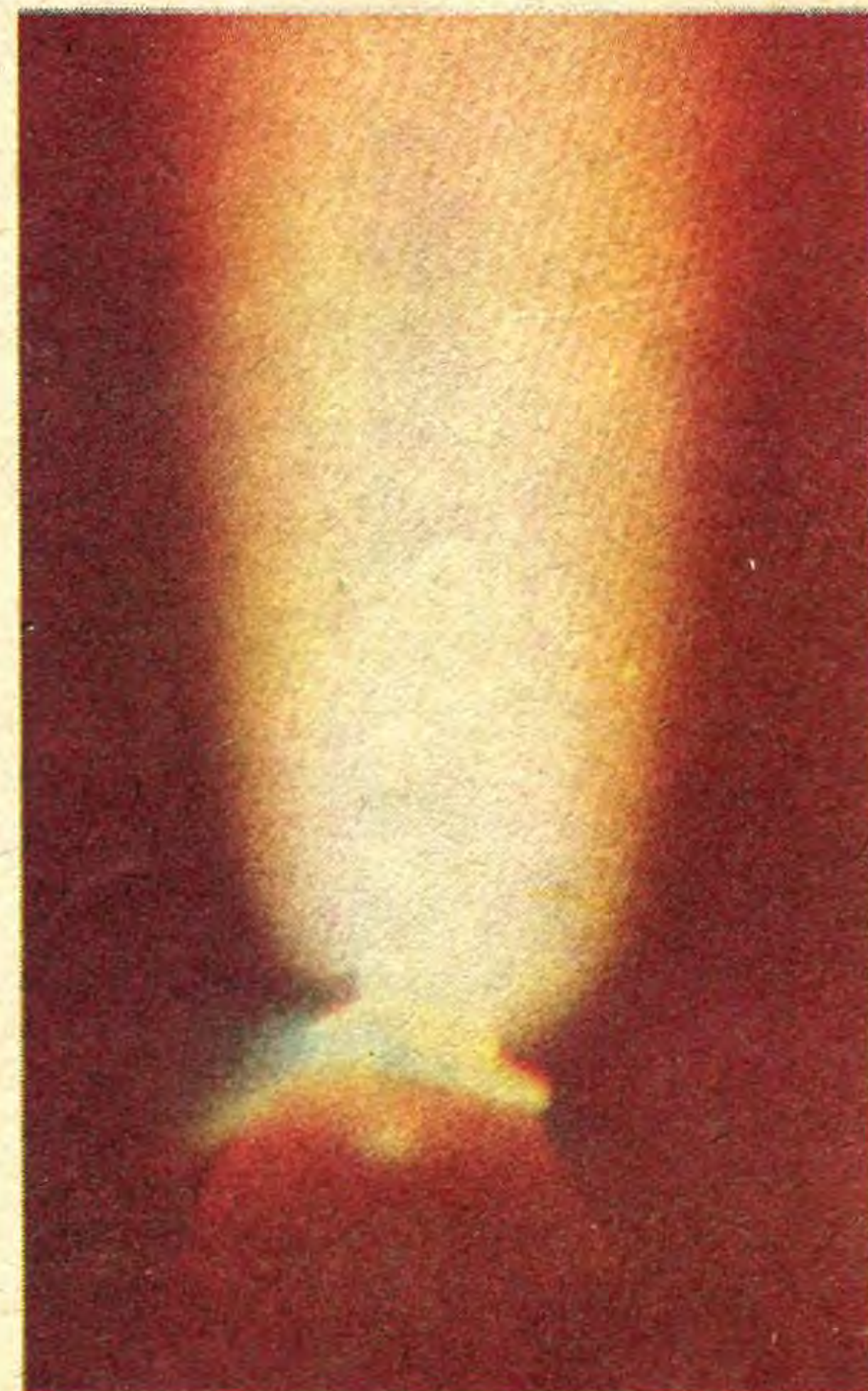
Рис. 5. Свечение плазмы в виде «тарелки», полученное в дуговом плазмотроне.
