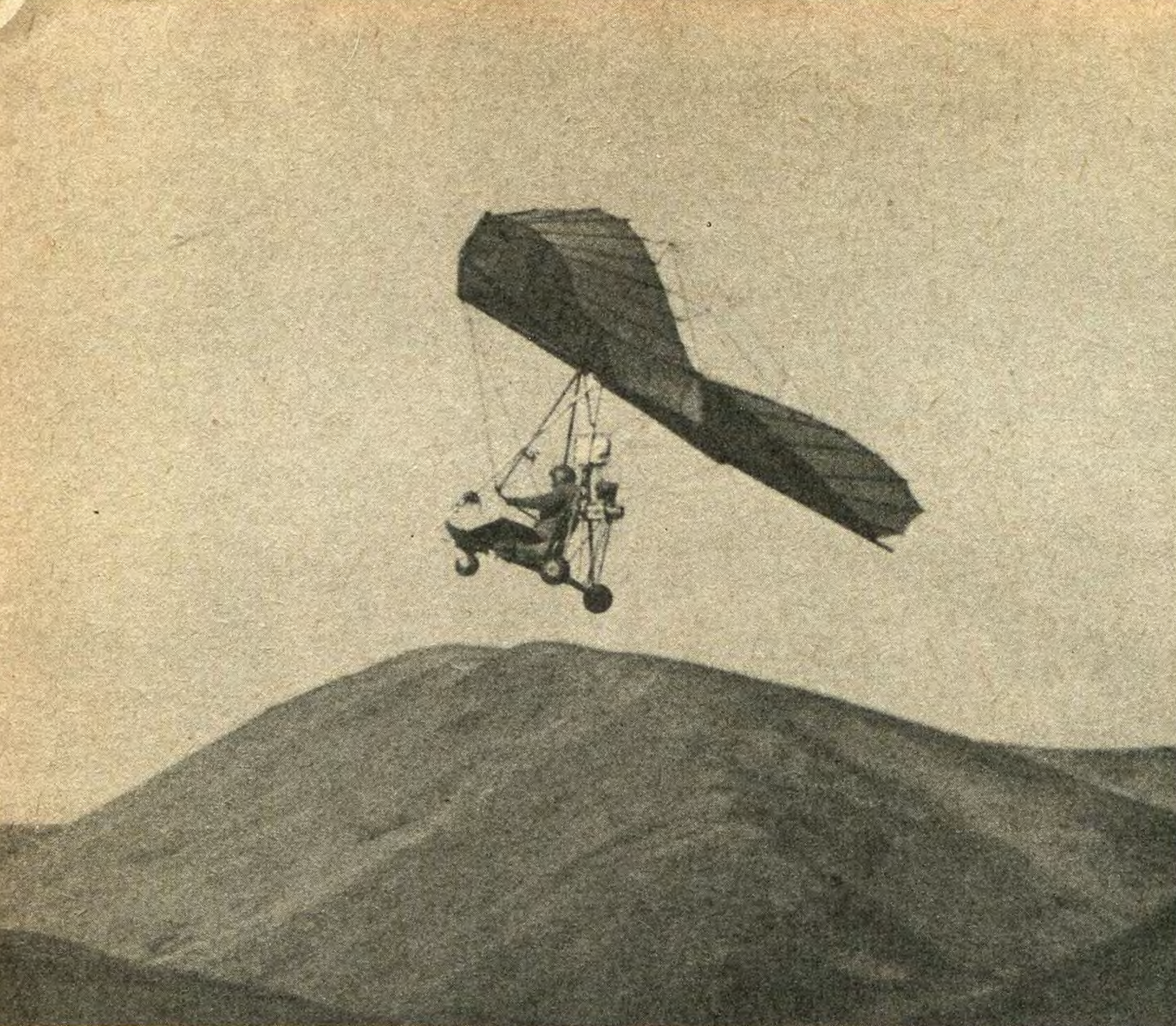
Чукотка, 1983 год. Сверхлегкий самолет «Поиск-02», оборудованный аппаратурой для аэрофотосъемки в полете.
