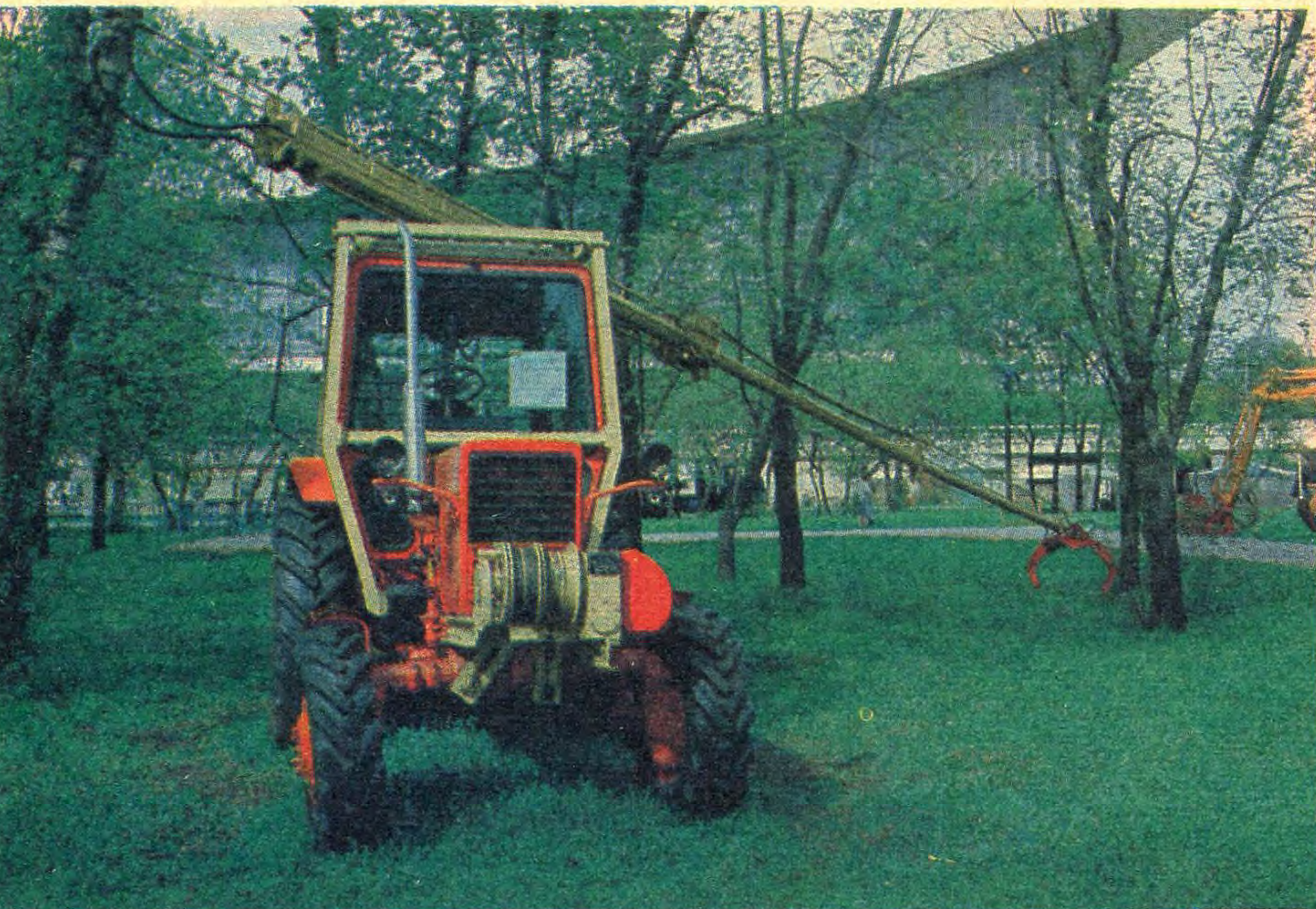
На базе нового трактора МТЗ-82 конструкторы смонтировали телескопический трелевочный манипулятор МТТ-10. Он облегчит труд работников лесного хозяйства.
