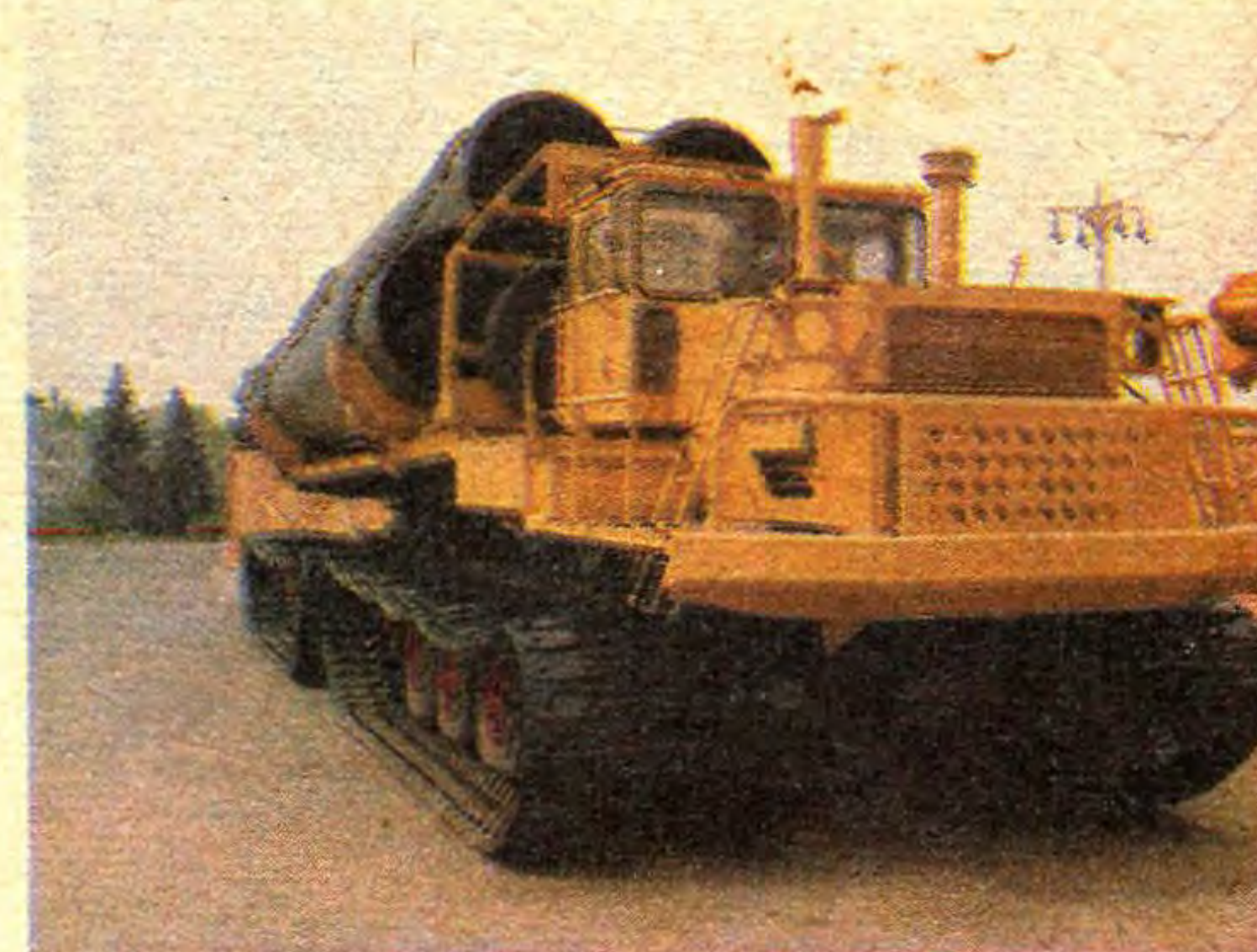
Новый трубовоз ТБ-301 поможет нефтяникам и газовикам осваивать месторождения Западной Сибири.
