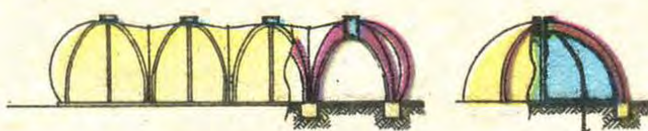
КАРКАСНО-ТЕНТОВОЕ СООРУЖЕНИЕ ШИРОКОГО НАЗНАЧЕНИЯ /С ДЕРЕВЯННЫМ АРОЧНЫМ КАРКАСОМ/
