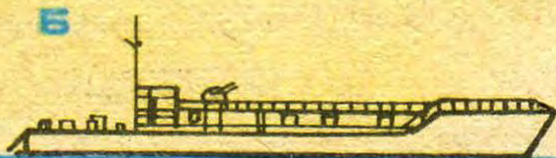
Б. Английский средний десантный корабль типа «Ок» (1946 г., 647 т, 69 м, 2000 л. с., 12 узлов. 700 солдат или 20 танков).
