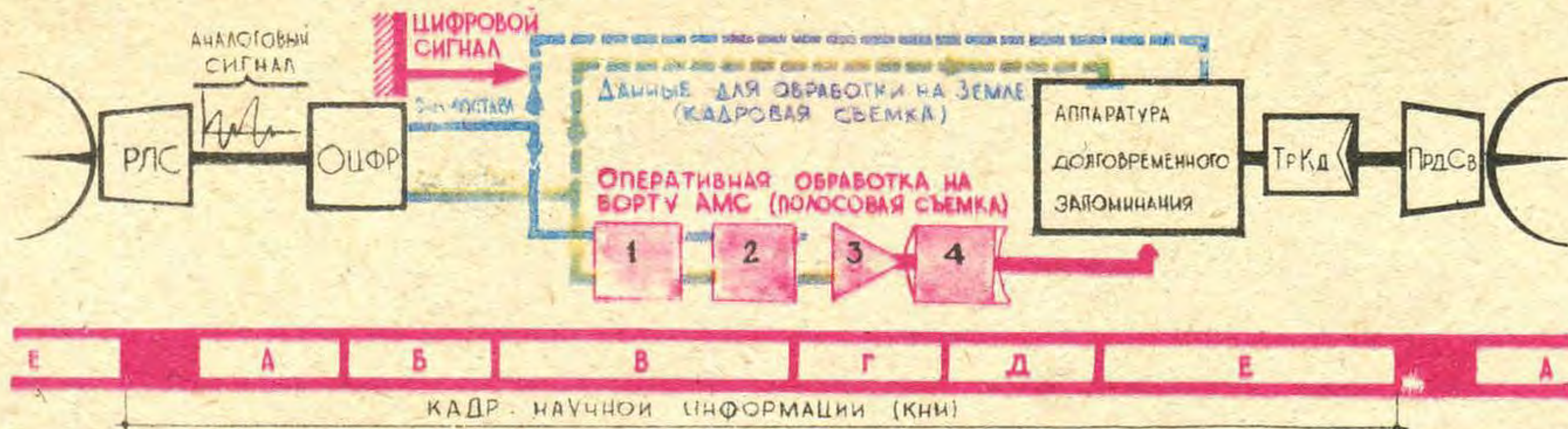
Рис. 5. Комплекс бортовой обработки данных РБО при помощи специализированной вычислительной машины.
