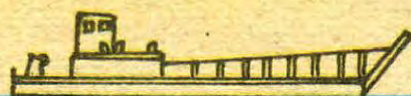
Г. Английский танкодесантный плашкоут LCM (7) (1944 г., 28 т, 18,3 м, 250 л. с., 9,8 узлов. Один средний танк).
