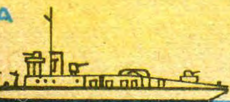
А. Десантная баржа типа F-177 (Германия, 1942 г., 180 т, 49,8 м, 450 л. с., 11 узлов).
