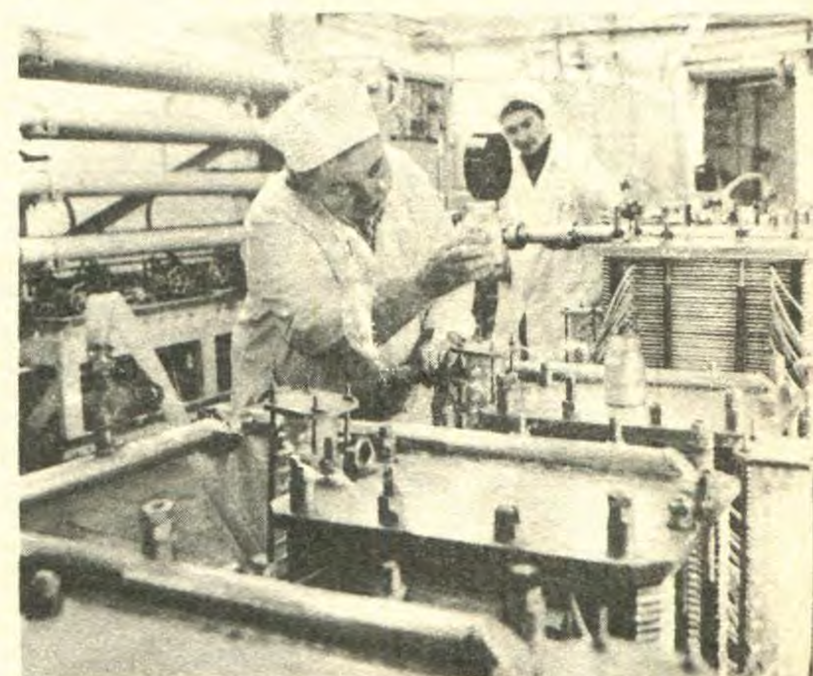
Установка для переработки молока мембранным способом.
