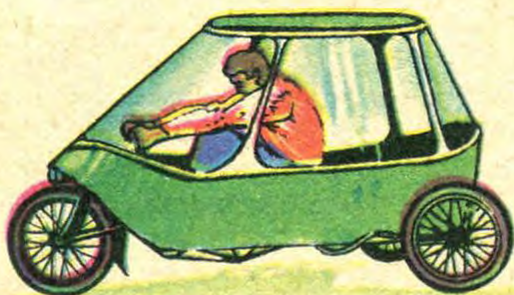
Этот велосомобиль приводится в движение посредством ног и рук.
