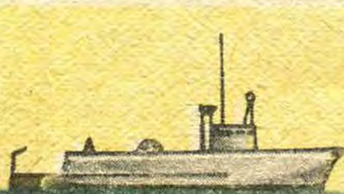
Катерный тральщик «МСВ» (США, 1951 год). 81 т, 10 узлов, мощность двигателя 600 л. с., контактный, акустический и электромагнитный тралы.
