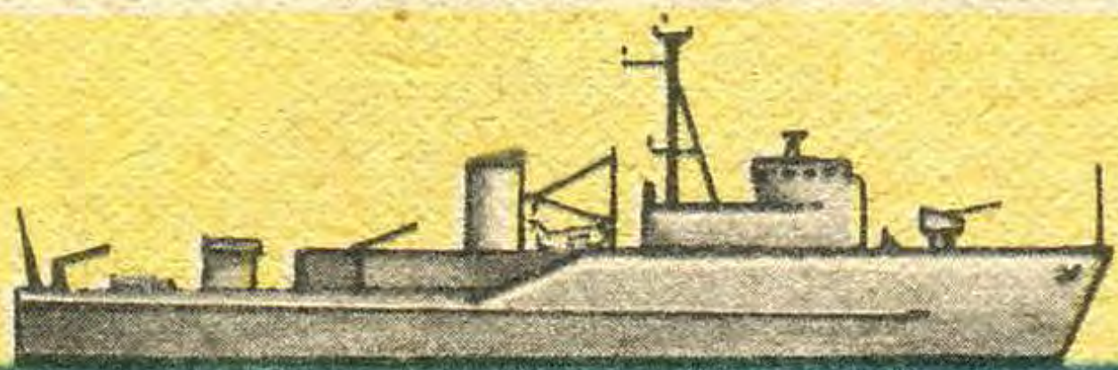
Опытный базовый тральщик «Уилтон» (Англия, 1973 год). 480 т, 16 узлов, мощность двигателей 3000 л. с. Вооружение: 1×40-мм автомат, контактный, акустический, электромагнитный тралы. Корпус из стеклопластика.
