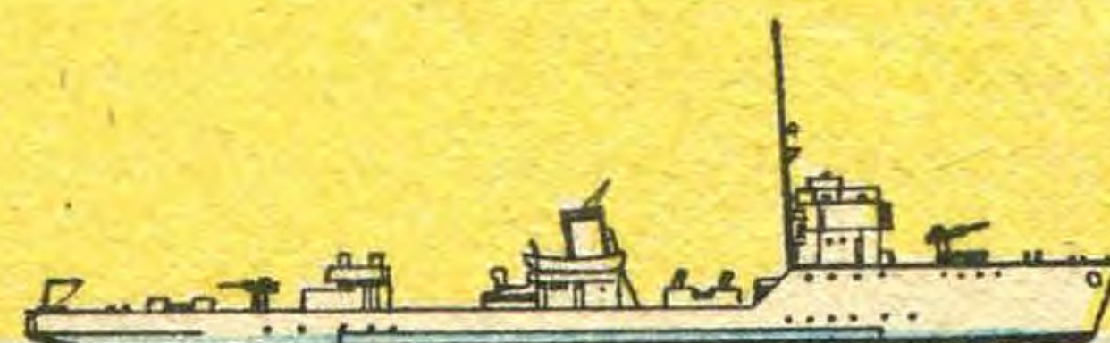
Базовый тральщик типа «Трал» (СССР, 1934 год), 410—450 т, 18 узлов, 1×100-мм орудие, 2×37-мм зенитки, 4 пулемета. Трали Шульца и змейковый. Мог принимать на борт до 27 мин.
