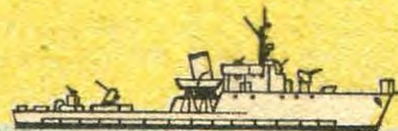
Рейдовый тральщик «Стотонник» (СССР), 150 т, 14 узлов, 2×45-мм пушки, 2 пулемета, 10 глубинных бомб.
