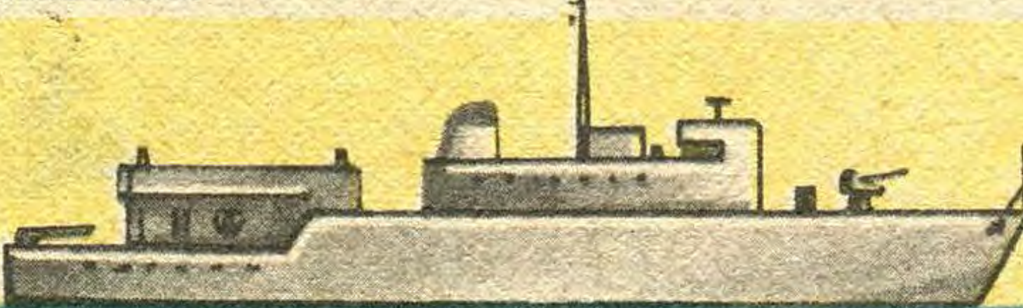
Тральщик — искатель мин «Брекон» (Англия, 1979 год). 725 т, 17 узлов, мощность двигателей 3540 л. с. Вооружение: 1×40-мм автомат, системы обнаружения и классификации подводных объектов, контактный, электромагнитный и акустический тралы. Корпус из стеклопластика.
