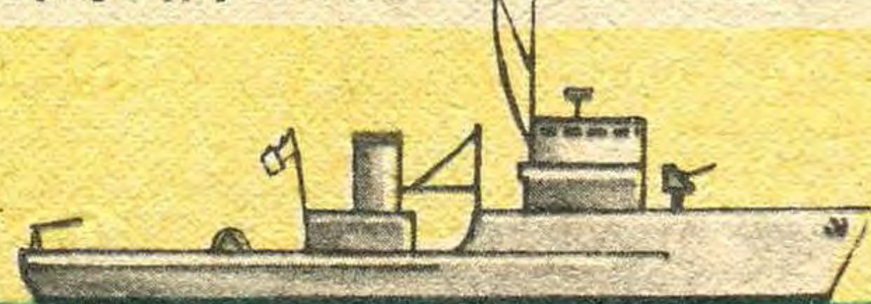
Английский базовый тральщик типа «Тон» (1953 г.). 425 т, 15 узлов, 1×40-мм автомат, 2×20-мм пулемета, контактный, электромагнитный, акустический тралы. Корпус композитной конструкции.
