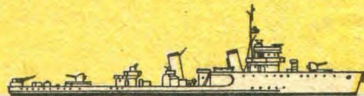
Эскадренный тральщик типа «Владимир Полухин» (СССР, 1939 год), 600 т, 24 узла, 2×100-мм, 3×37-мм пушки, 2×20-мм автомата, 4 крупнокалиберных пулемета, кроме тралов имелось размагничивающее устройство.
