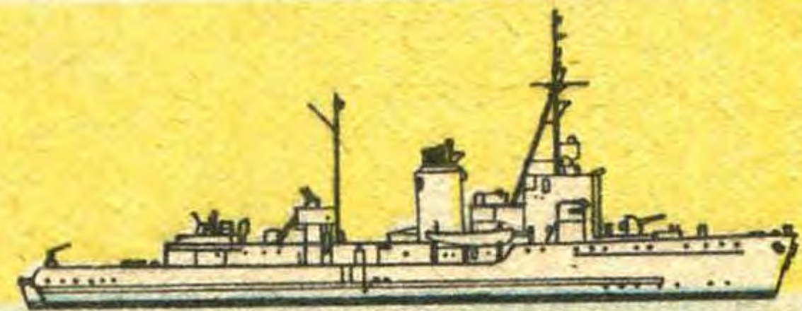
Морской тральщик типа «МЛР» (Германия, 1944 год), 460 т, 15 узлов, 1×105-мм орудие, контактные и неконтактные трали.
