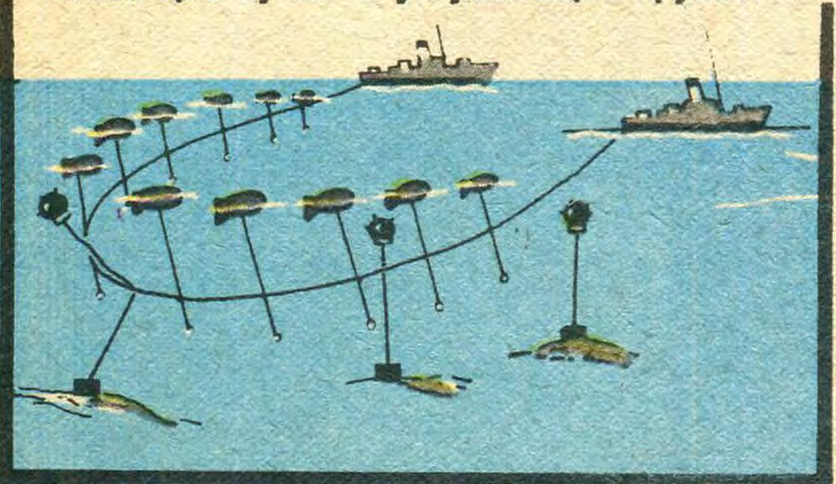
Змейковый трал удерживается на заданной глубине щитком (справа внизу) и «подводным змеем» (слева, под буйком).
