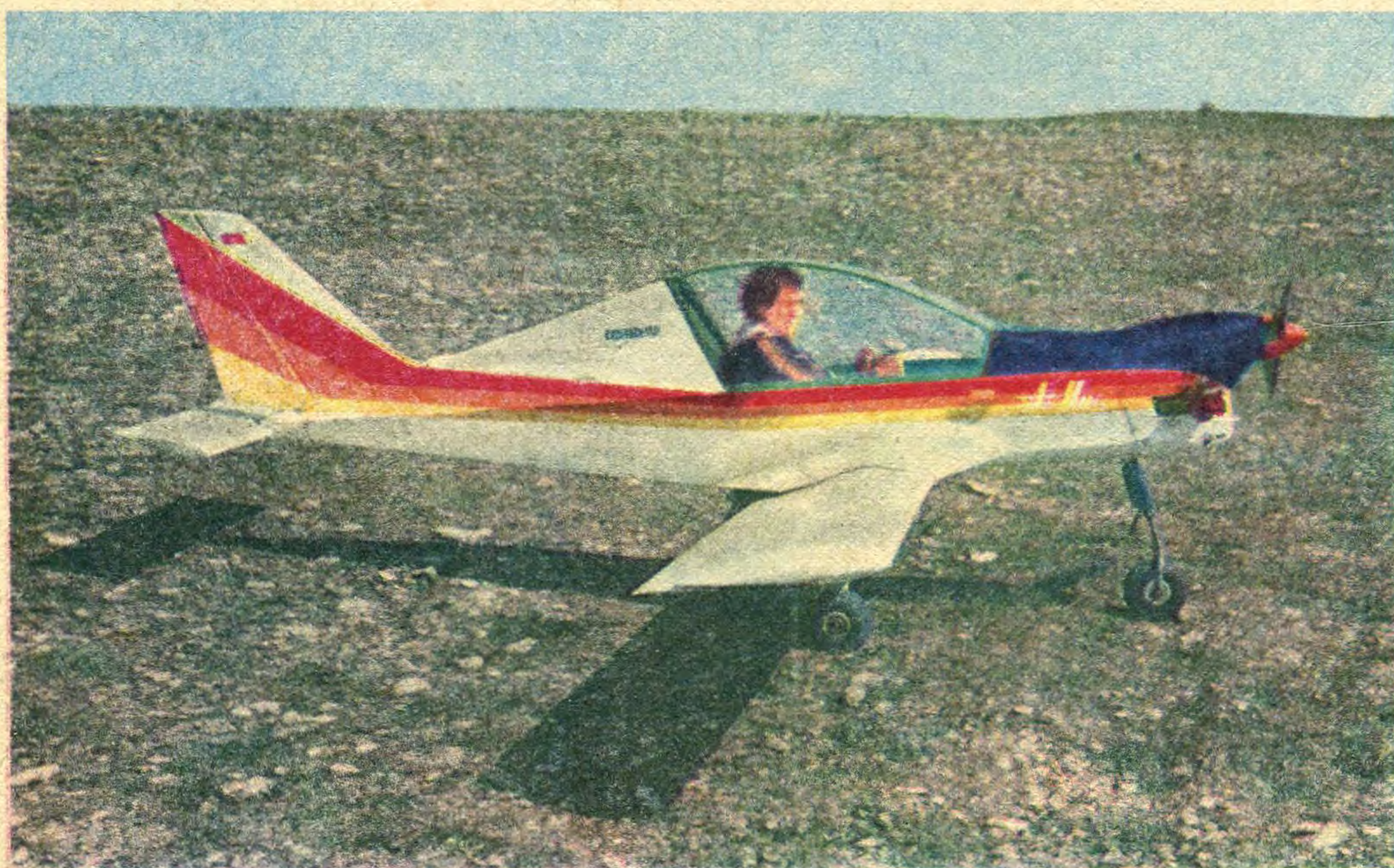
Микросамолет МКБ «Аэропракт» при КЮТ «Поиск» А-11-М «Гамлет» (руководитель И. ВАХРУШЕВ, II премия) может применяться как спортивно-тренировочный и самолет специального назначения.
