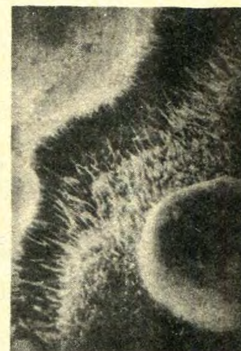
Поверхность окисленных частиц медного порошка (наличие игл, бугорков, трещин объясняет причину разной химической активности таких частиц).
