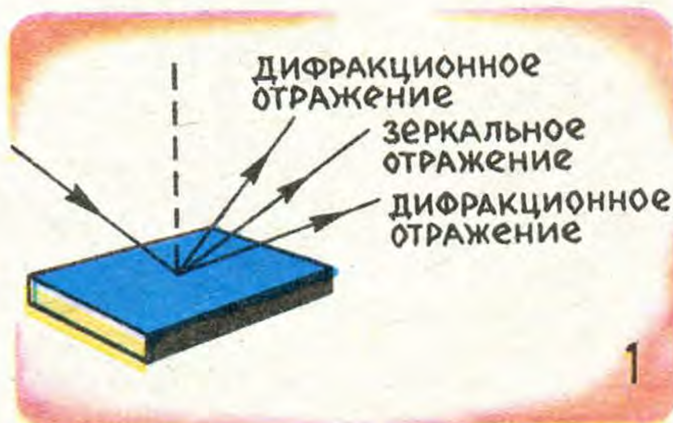
Дифракция атомов гелия на поверхности кристалла фтористого лития (схема опыта и на графике — его результаты).
