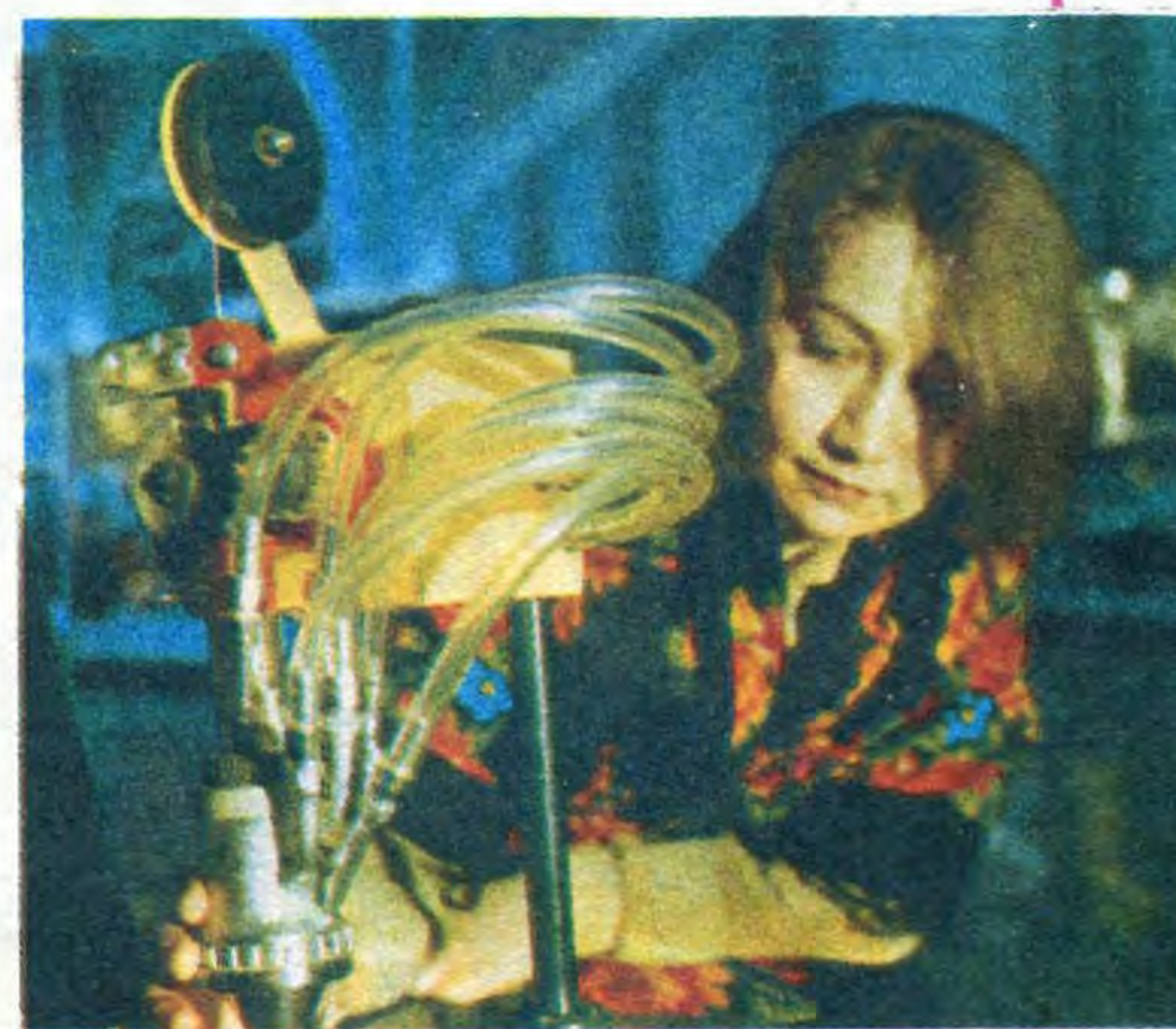
Универсальный плазматрон для дуговой сварки цветных металлов и сталей. Фото Б. Иванова.
