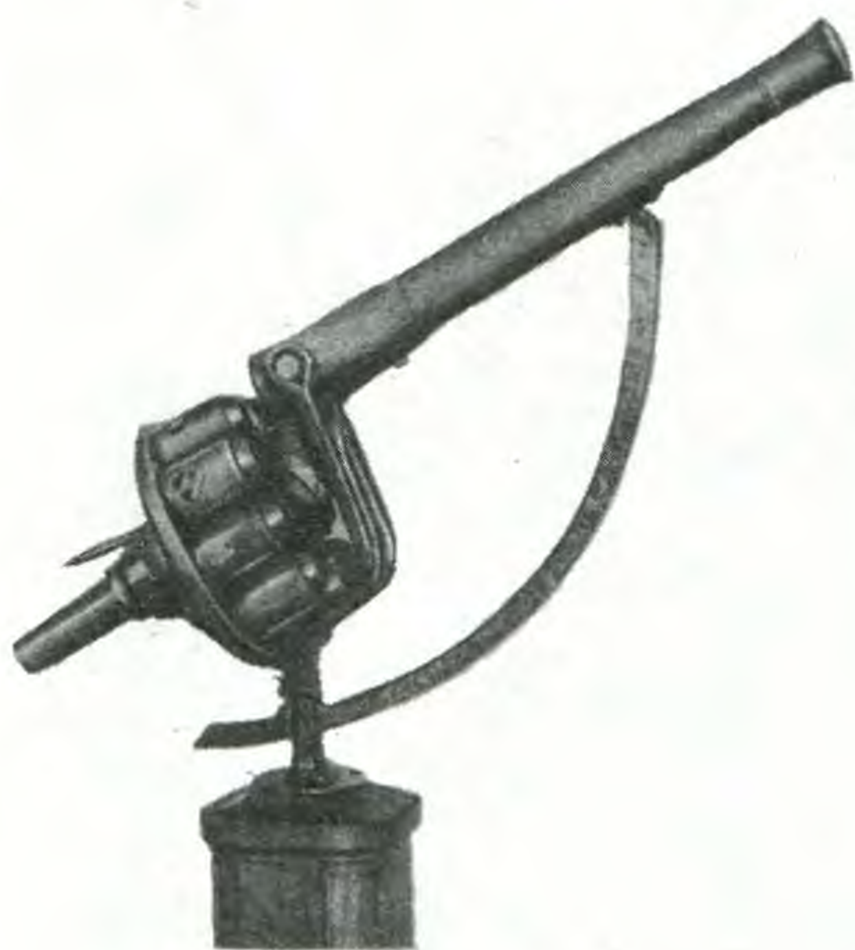
«Предок» современных автоматических систем — семиканальная пушка 1750 года.
