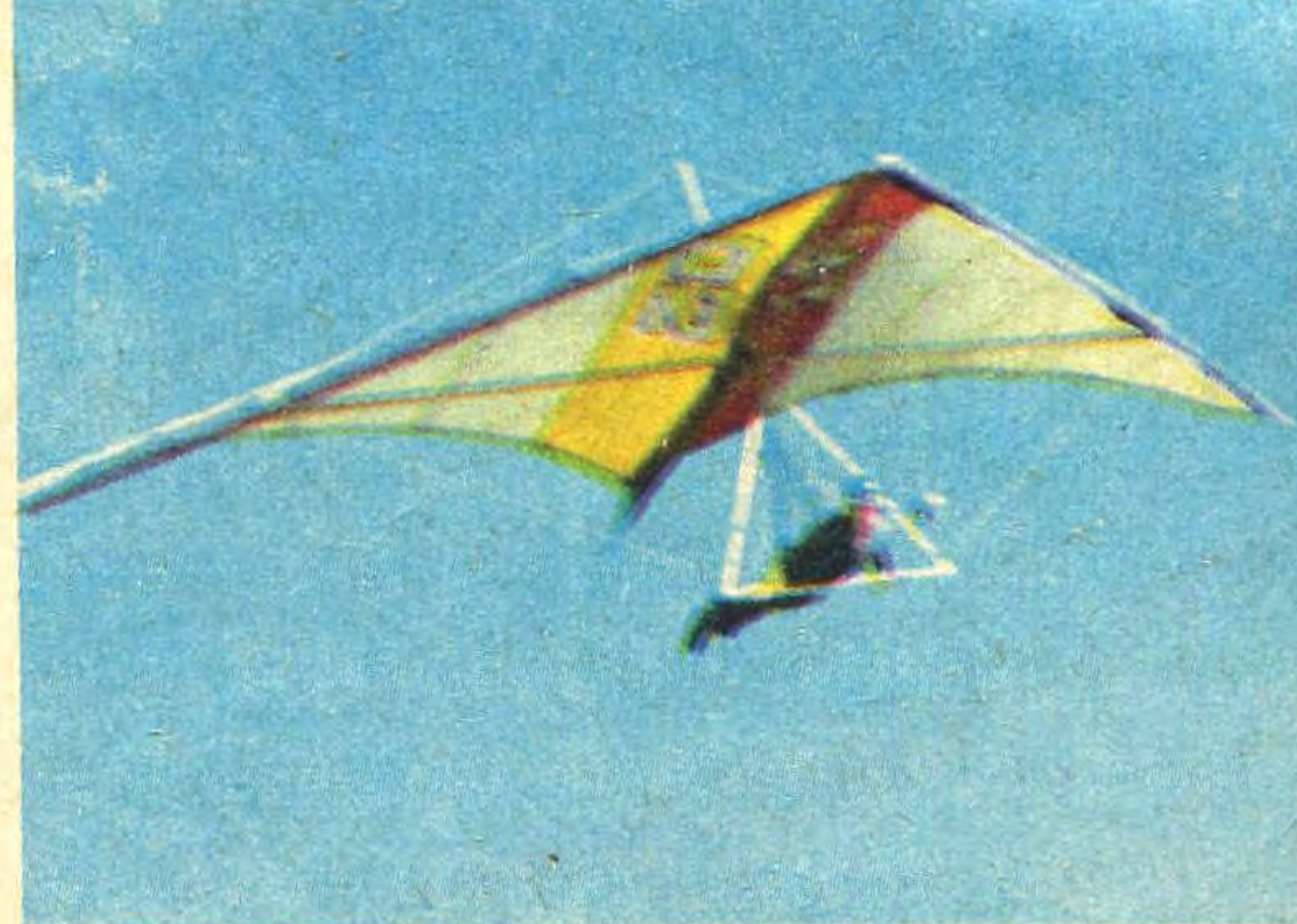
Рис. 1. Аппарат Д. Нор-Аревяна характерен широким боковым карманом, надуваемым встречным потоком воздуха, что увеличивает подъемную силу. Верхняя поверхность профиля более изогнута в передней части. Значительная кривизна передней части дает увеличение коэффициента подъемной силы и аэродинамического качества на больших углах атаки. Антипикирующее устройство: 1 — жесткая поддержка концевых частей крыла для сохранения формы купола (разрез В-В); 2 — подвязка двух лат.
