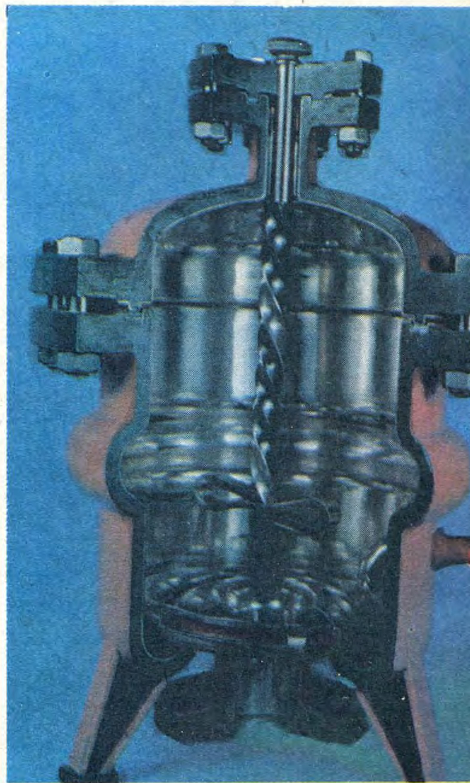
Реактор размером 3 \times 1,86 м, плакированный серебром. Экономический эффект 2 млн. руб.
