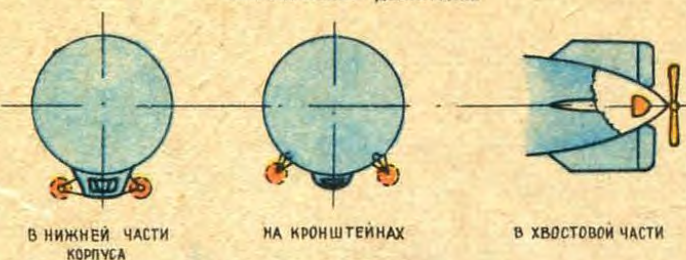
Варианты расположения силовой установки в нижней части фюзеляжа дирижабля.
