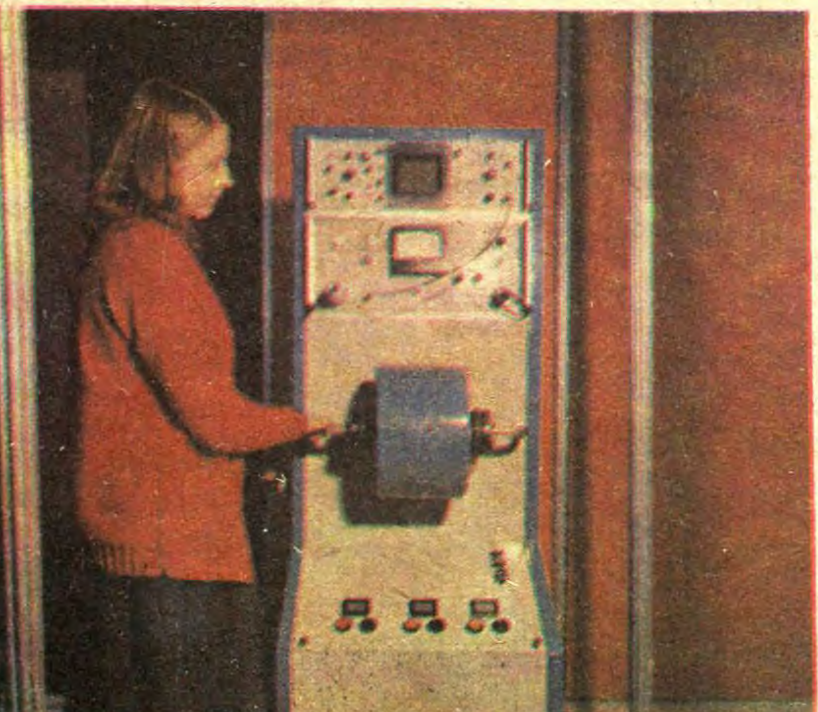
Ю. Лаят и У. Лейв из Таллинского политехнического института показали москвичам электронный расходомер для мгновенного определения скорости в напорных технологических системах.
