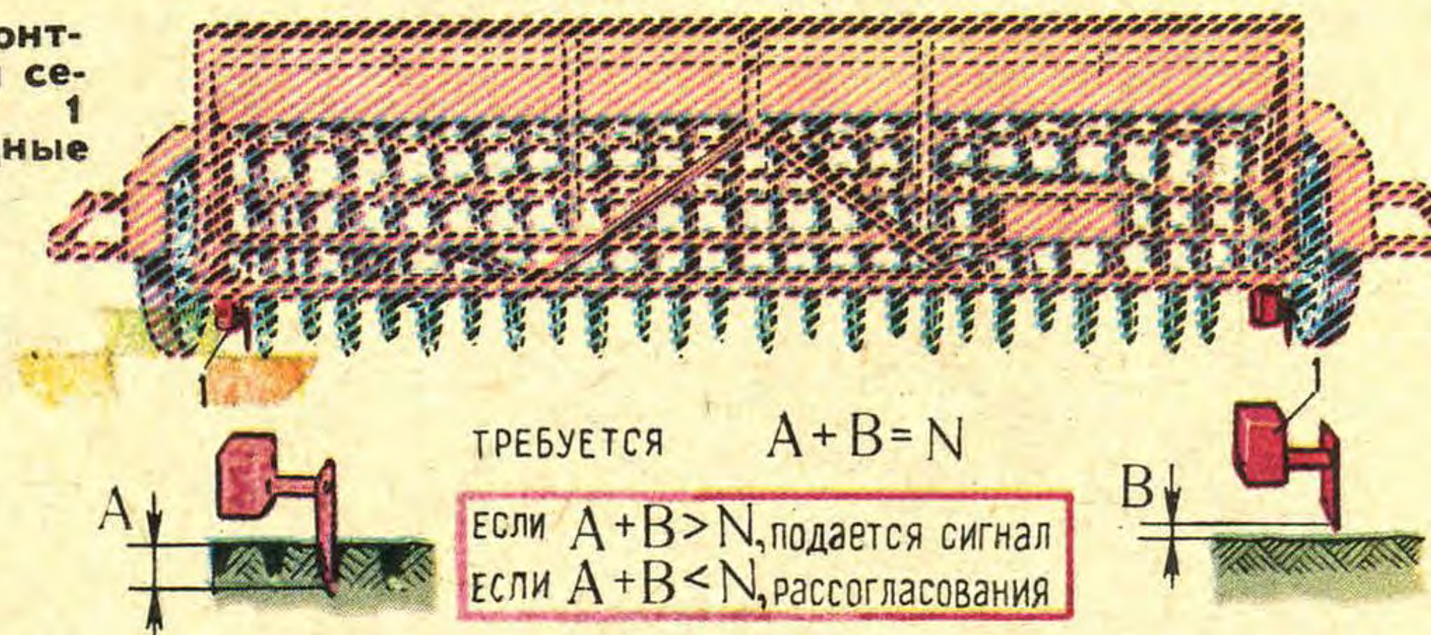
Рис. 2. Система контроля за исправностью сошников и высевом семян. Цифрами обозначены: 1 — источник света; 2 — горловина сошника; 3 — фотосопротивление; 4 — световой сигнал; 5 — звуковой сигнал.
