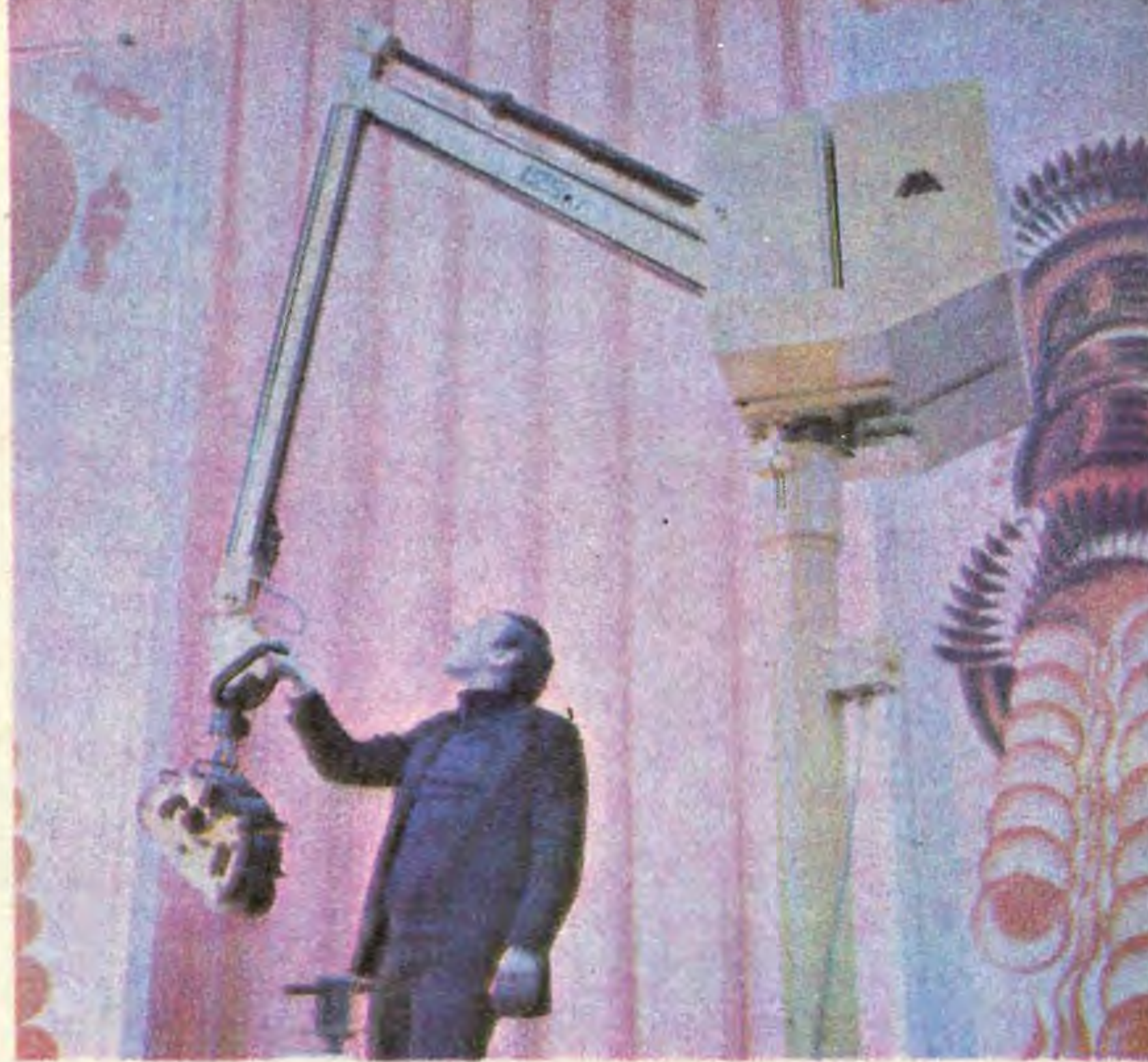
Универсальный манипулятор с сервомеханическим приводом предназначен для перестановки деталей со станка на станок и погрузки-разгрузки всевозможных предметов. Прибор разработан группой московских изобретателей.
