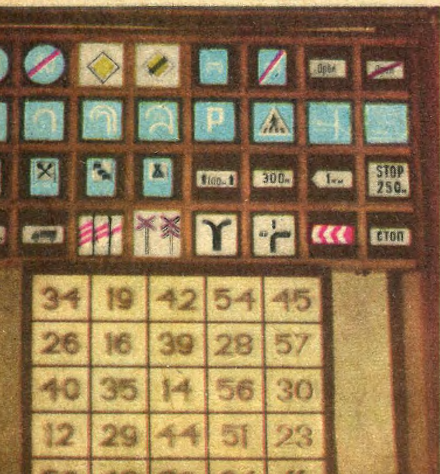
Стенд с изображением дорожных знаков цифровое табло для проверки времени реакции водителя.
