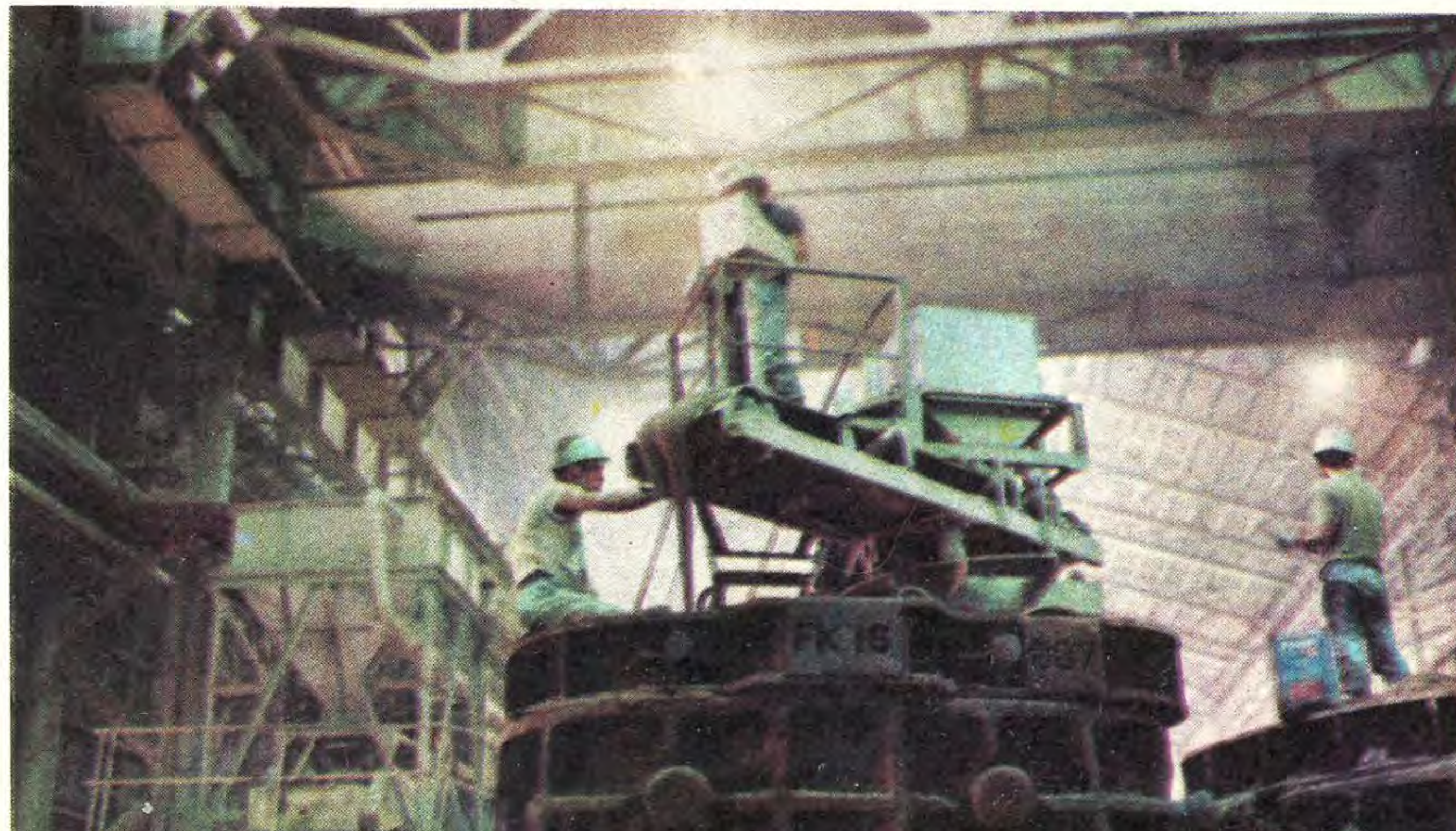
В Японии литейные формы с применением жидких самотвердеющих смесей давно производят по советской лицензии.
