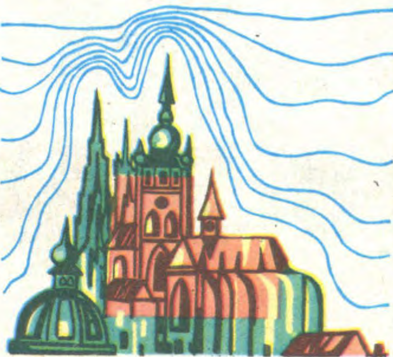
Рис. 2. Так эквипотенциальные поверхности огибают высокие здания и другие возвышенности.
