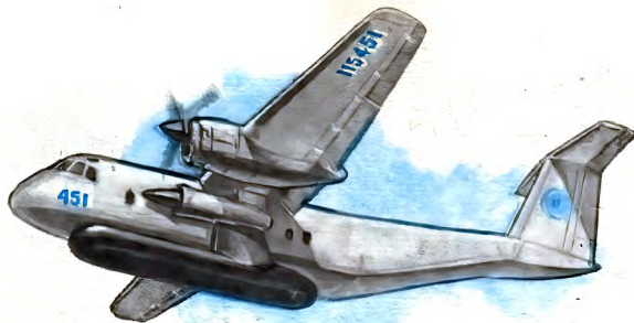
Проект самолета с шасси на воздушной подушке.
