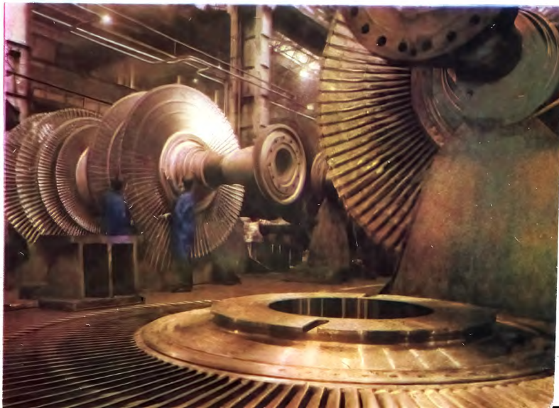
Советские турбостроители готовят к выпуску паровые турбины мощностью 1000 и 1200 Мв.
