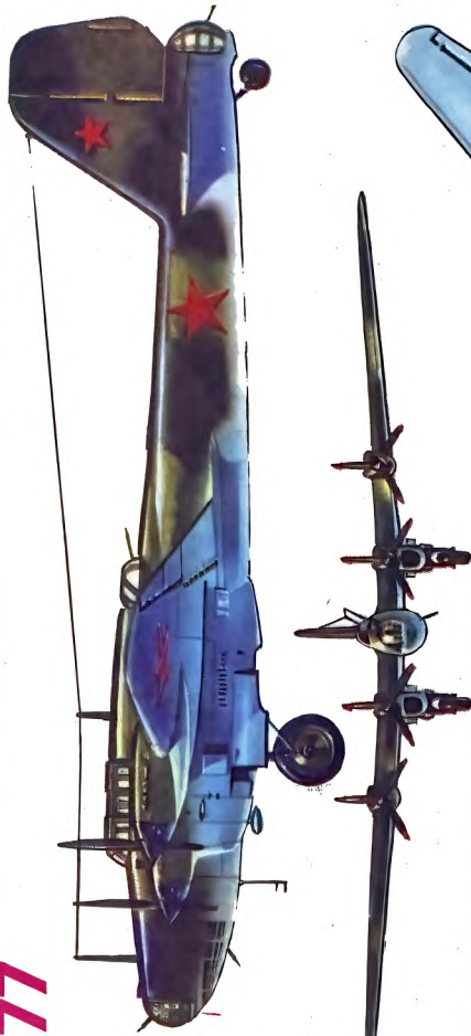
77. Бомбардировщик Пе-8 (СССР, 1939). Двигатели — 4 × АМ-35А по 1350 л. с. Длина — 24,5 м. Размах крыла — 40,00 м. Площадь крыла — 188,66 м². Взлетный вес (макс.) — 32 000 кг. Скорость максимальная — 440 км/ч. Потолок практический — 10 300 м. Дальность полета — 4700 км. Бомбовая нагрузка (максимальная) — 2 тыс. кг. Оборонительное вооружение — 2 пушки 20 мм, 2 пулемета 12,7 мм. В 1942 году самолет оснастили двигателями воздушного охлаждения АШ-82ФН (1850 л. с. каждый).
