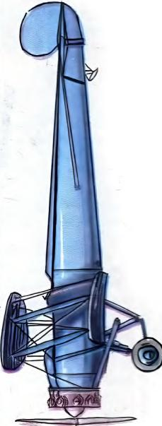
51. Учебный самолет «Альбатрос L30 (BII)» (Германия, 1915). Двигатель — «Мерседес», 120 л. с. Площадь крыльев — 40,6 м<sup>2</sup>. Вес пустого — 737 кг. Полетный вес — 1050 кг. Скорость максимальная — 120 км/ч. Полоса стартовая — 3000 м. Дальность — 500 км.
