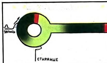
Рис. 8. Схема ячейки памяти.
