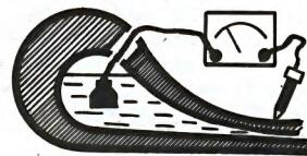
кость, электропроводность которой превосходит проводимость материала, из которого она сделана. К внешней стороне подводят латунный щуп, соединенный через омметр с электродом, опущенным в жидкость. Показания омметра, отградуированного в линейных единицах, при перемещении щупа меняются в зависимости от толщины стенок. Для каждого материала у омметров своя шкала единиц.
