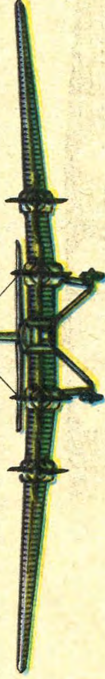
29. ТБ-3 (СССР, 1933). Двигатели — 4хМ-17Ф, по 715 л. с. Размах — 39,5 м. Площадь крыла — 230,0 м 2 . Длина — 24,4 м. Вес пустого — 10 967 кг. Полетный вес — 17 200 кг. Полная нагрузка — 6233 кг. Скорость максимальная — 197 км/ч. Потолок практический — 3800 м. Радиус действия — 1350 км. Полетный вес ТБ-3 выпуска 1935 года с двигателями М-34РН составлял 18 877 кг, максимальная скорость 288 км/ч.
