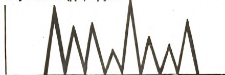
Рис. 9. Экспериментальная кривая «тока действия» при подъеме груза.
