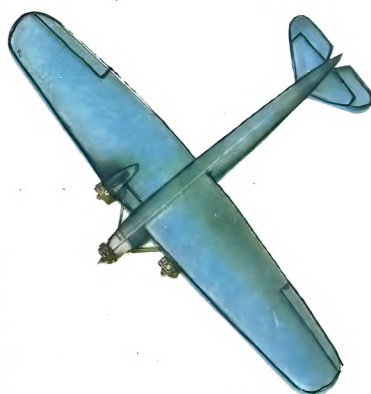
22. «Фоккер» F-VII взлёт (Голландия, 1926). Двигатели 3Х «Райт Уайрленд» J5-С по 223 л. с. Размах — 21,71 м. Длина — 14,5 м. Площадь крыла — 67,6 м 2 . Взлётный вес — 6964 кг. Вес пустого — 2830 кг. Скорость максимальная — 207 км/ч. На самолёте такого типа американская летчица Амалия Эрхарт 17 июля 1928 года перелетела через Атлантику.
