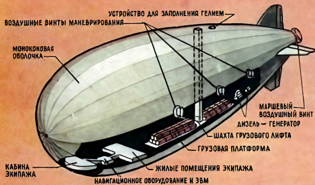
Гибридный летательный аппарат американской фирмы «Мегалифтер компани» (п р о е к т).
