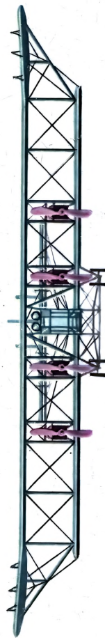
10. «Илья Муромец», серия В (Россия, 1914). Экипаж — 4 чел. Двигатели — «Аргус» (2×140 л. с. и 2×125 л. с.). Полетный вес — 4400 кг. Размах — 29,8 м (верхнее крыло), 21,0 м (нижнее). Длина — 17,10 м. Площадь крыльев — 125 м². Полная нагрузка — 1500 кг. Максимальная скорость — 120 км/ч. Вооружение — 3 пулемета, 500 кг бомб.
