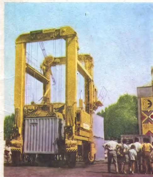
«Тяжелое орудие» будущих контейнерных пунктов — «Балканкар — Керикон», машина совершенно нового типа, могущая укладывать контейнеры в 3 яруса по высоте.
