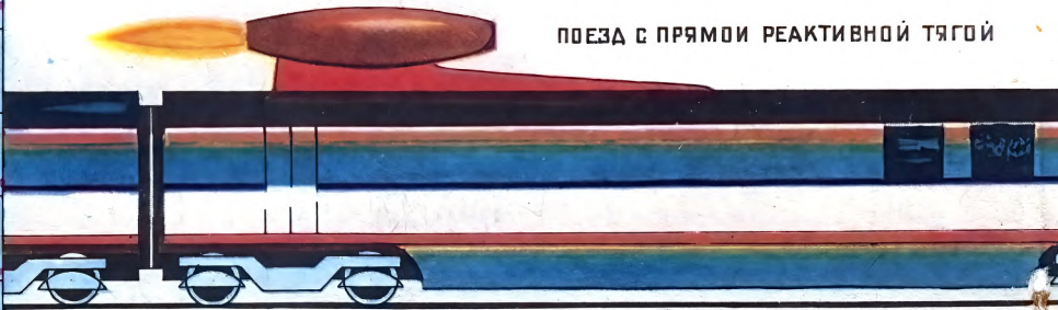
Авиационный турбореактивный двигатель установлен на крыше вагона.
