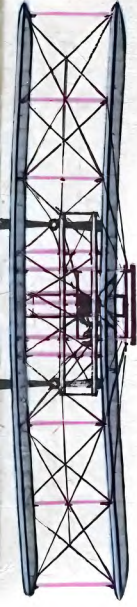
Вверху изображен биплан братьев Вуазен (Франция, 1909). Двигатель 8-цилиндровый, водяного охлаждения, 60 л. с. Площадь крыльев — 40 м 2 . Размах — 10 м. Полетный вес — 600 кг. Скорость — 55 км/ч.
